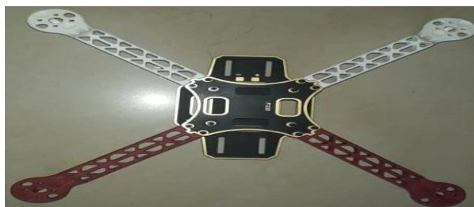
Figura 10 Estructura cuadricóptero DJI FW450.
