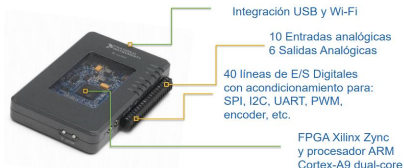
Figura 3 Características físicas de la tarjeta NI MY-RIO.
