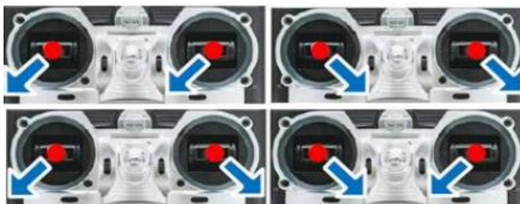
Figura 16 Armado y desarmado lógico de motores.
