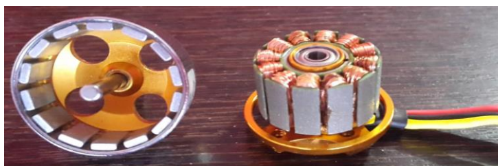
Figura 12 Componentes de un motor brushless.
