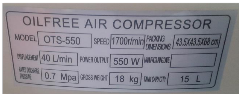
Figura 23 Placa de características del compresor OTS-550
