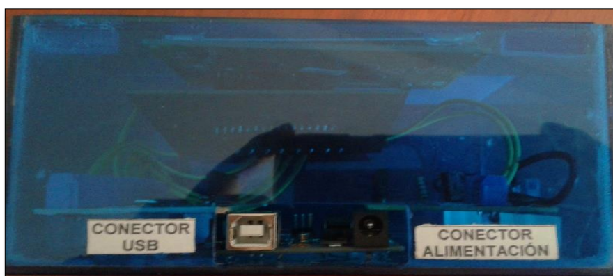
Figura 48 USB y conector de la fuente de alimentación externa
