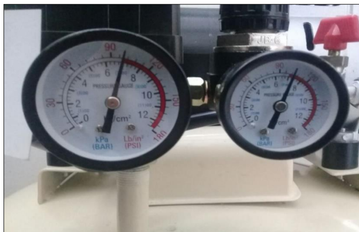
Figura 27 Presión máxima del compresor OTS-550
