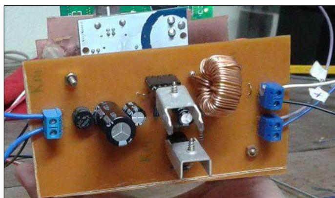
Figura 44 Colocación de los disipadores de calor
