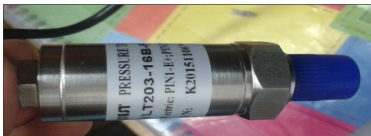
Figura 18 Transmisor de presión YLT 203-16B-G4-A
