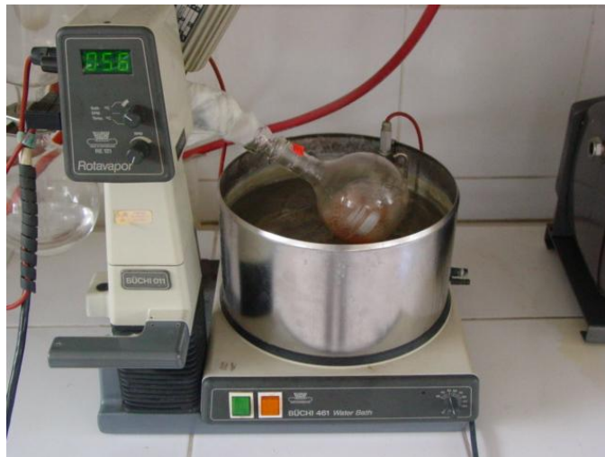
Rotavapor utilizado para concentrar la muestra a analizar
