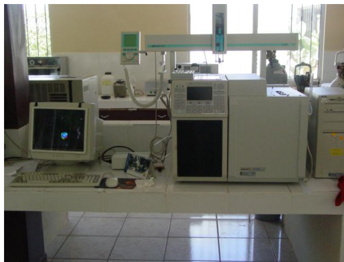
Equipo de cromatografía de gases marca Varian con detector TSD específico para plaguicidas organofosforados
