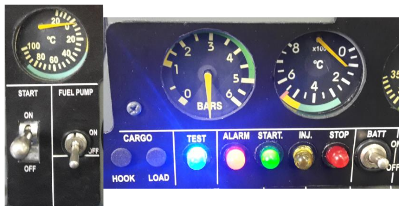
Figura 36: Secuencia de encendido /arranque, interruptor triple en RUN en la maqueta
