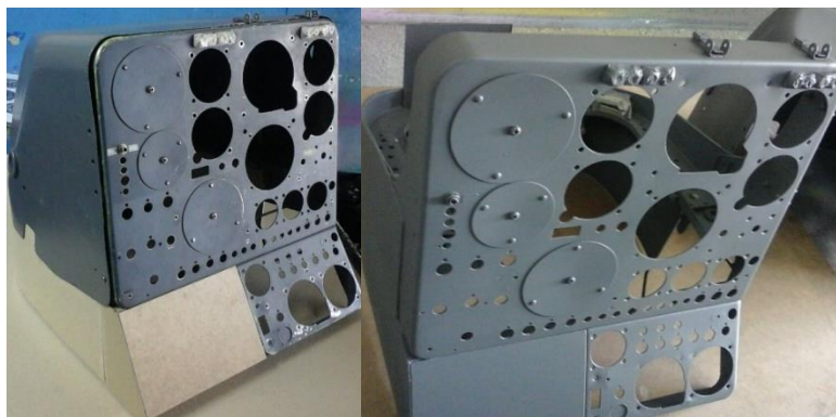
Figura 18: Remoción de pintura de la carcasa del panel frontal de instrumentos.
