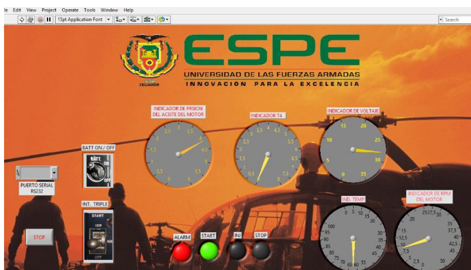
Figura 37: Secuencia de encendido /arranque, interruptor triple en RUN en LabVIEW (panel frontal).
