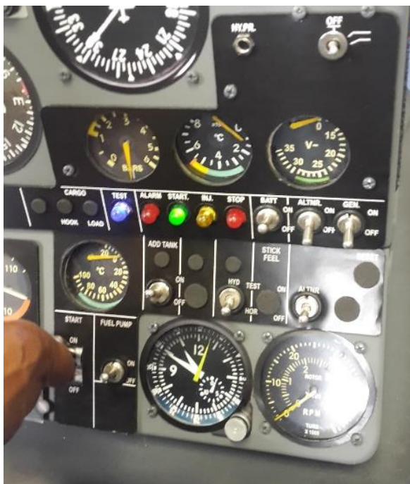
Figura 38: Secuencia de encendido /arranque, interruptor triple en INJ en la maqueta.
