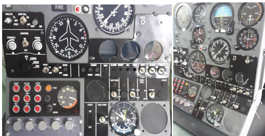
Figura 19: Elaboración del panel de instrumentos y colocación de señalética y caratulas de instrumentos.
