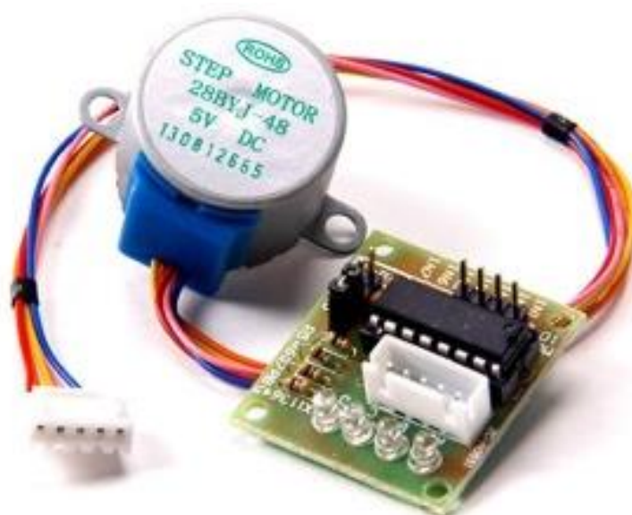
Figura 14: Motor de pasos 28 BYJ-48 con driver ULN 2003.
