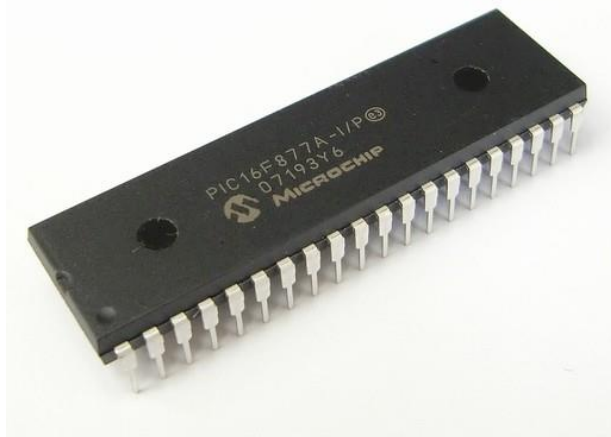
Figura 8: Microcontrolador 16f877A de fabricación norteamericana.
