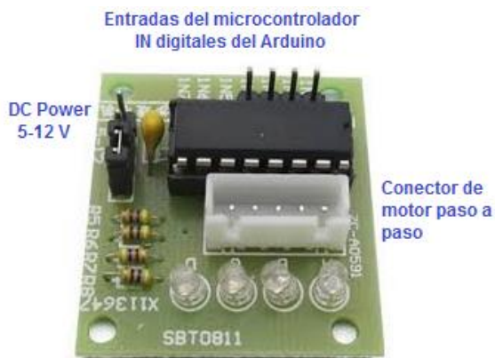
Figura 15: Tarjeta de control del motor 28by-48.
