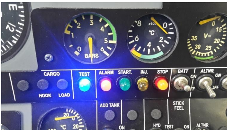
Figura 34: Pruebas de funcionalidad del interruptor batt, en la maqueta
