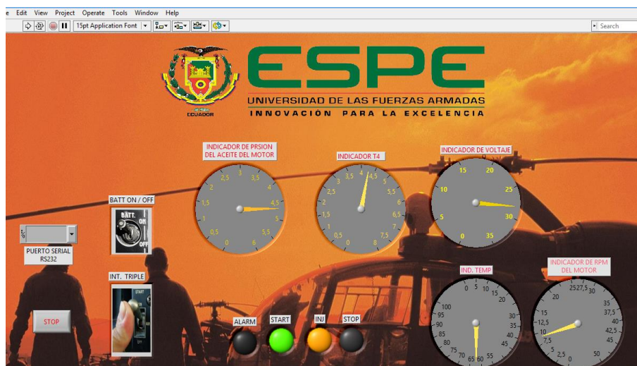
Figura 39: Secuencia de encendido /arranque, interruptor triple en INJ en labwiev (panel frontal).
