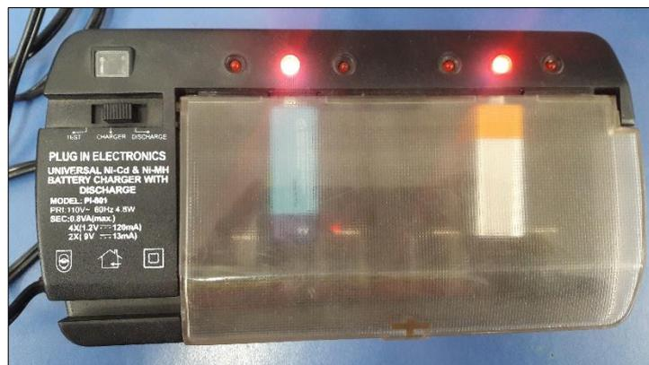
**Figura 34** Cargador de Baterías de 9V
