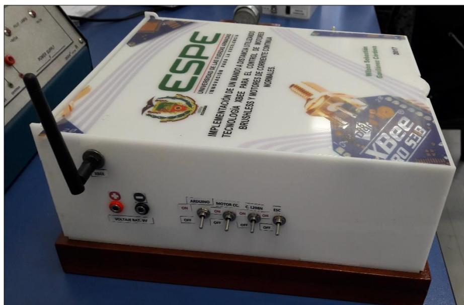
**Figura 79** Interruptores de encendido del receptor
