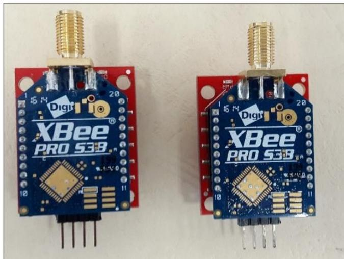
**Figura 20** Módulos XBee-PRO S3B 900HP
