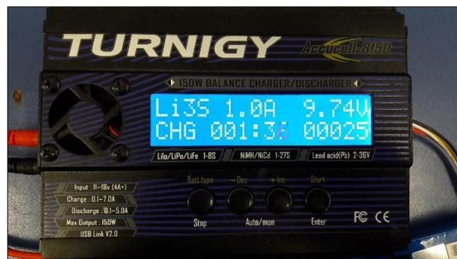
**Figura 32** Cargador de Baterías de LiPo
