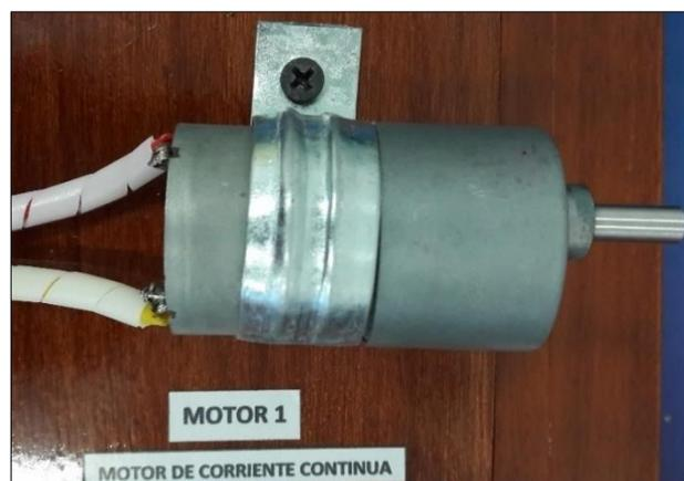
Figura 25 Motor de Corriente Continua 100:1
