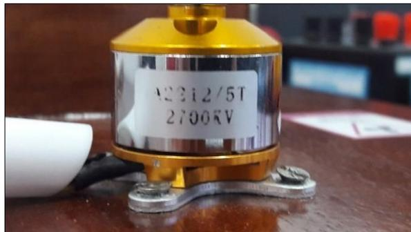
Figura 24 Placa de identificación Motor Brushless
