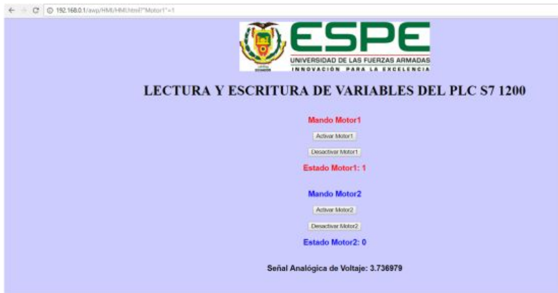
Figura 48 HMI para la lectura y escritura de variables del PLC.
