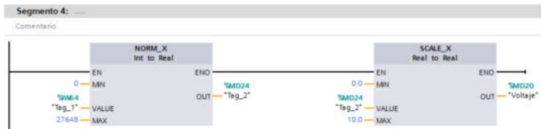
Figura 46 Escalamiento de la señal analógica a voltaje.
