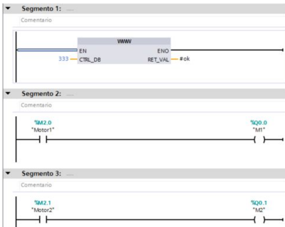
Figura 45 Activación de salidas digitales mediante marcas internas.
