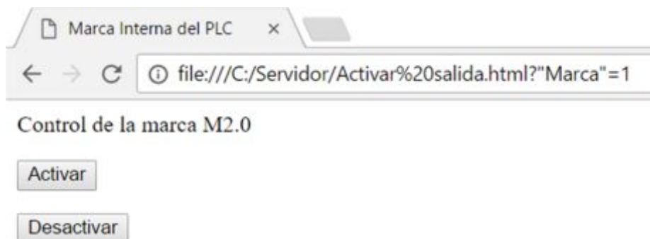
Figura 36 Página web para el control de la marca interna M2.0 del PLC.
