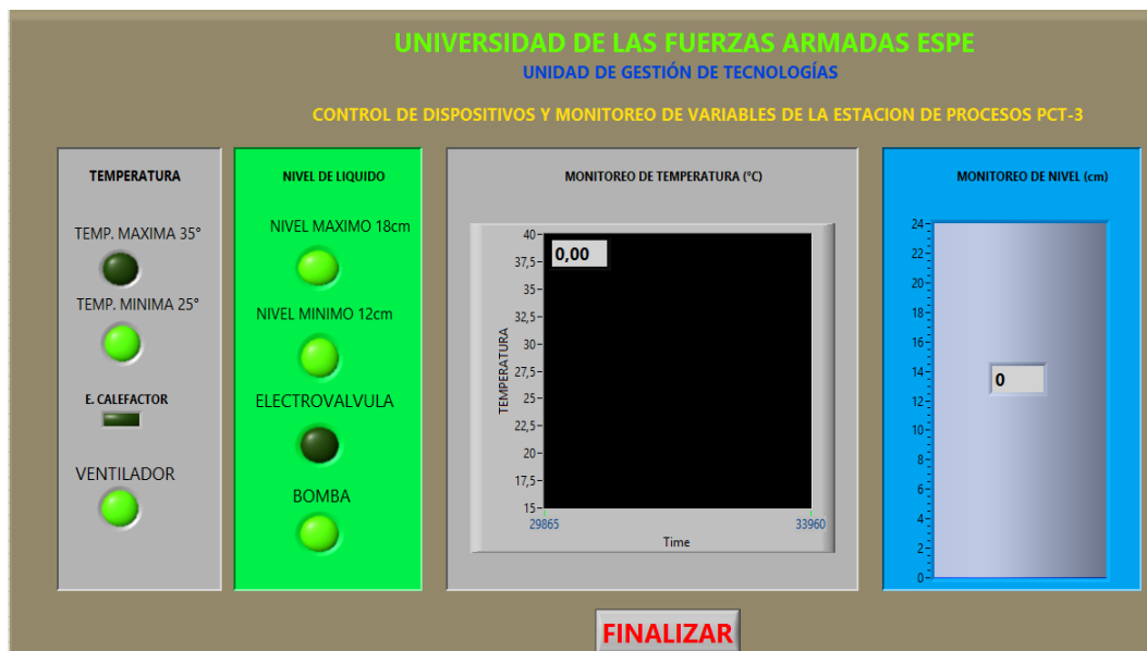
Figura 48 Instrumento virtual panel frontal del HMI
