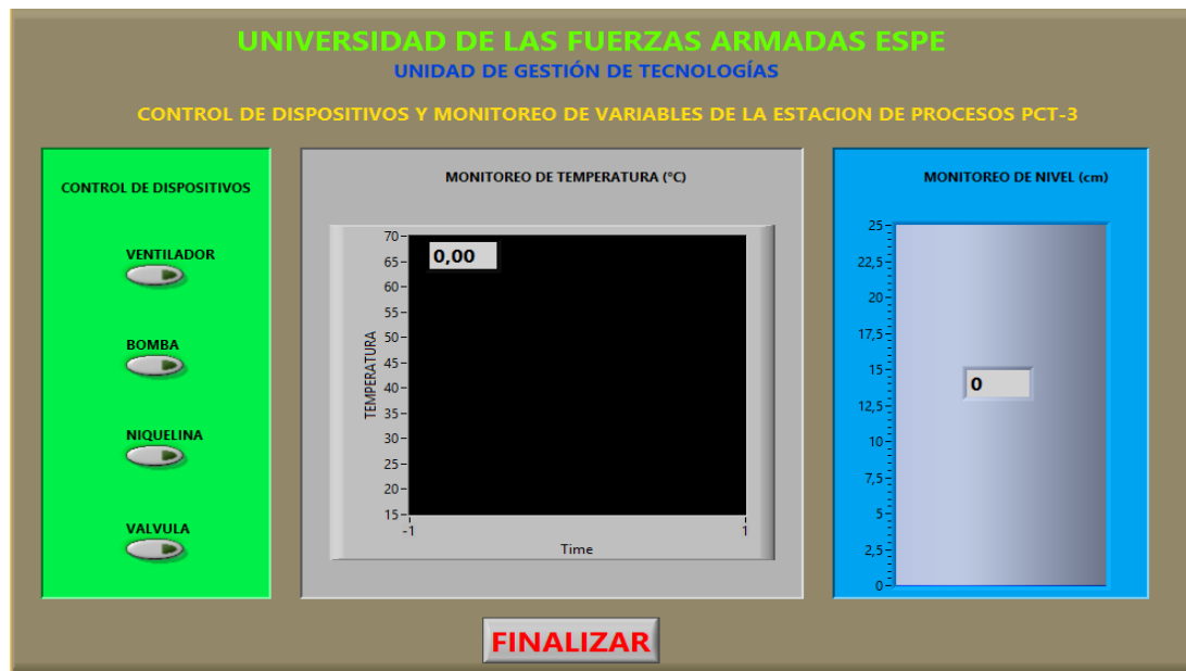
Figura 45 Control manual, monitoreo de temperatura y nivel de líquido.
