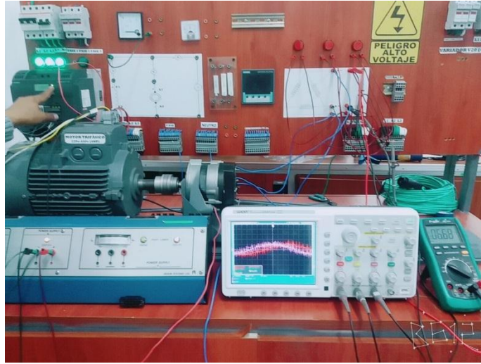
Figura 35 Generador de corriente alterna a 20hz
