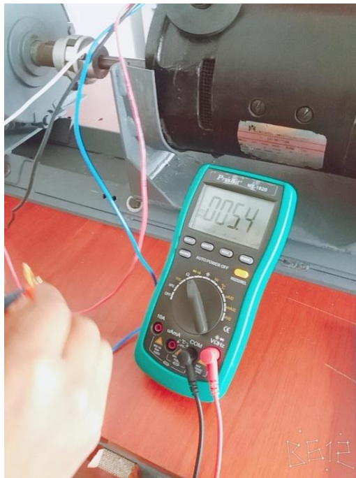
Figura 28 Medición de la armadura
