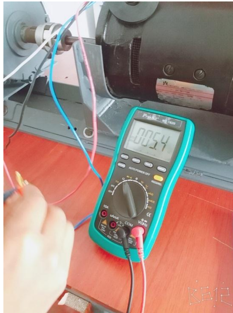
Figura 21 Medición de la armadura
