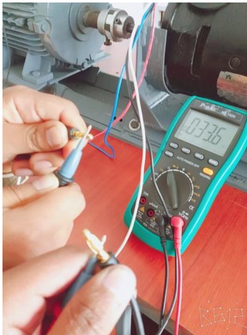
Figura 22 Medición de la resistencia
