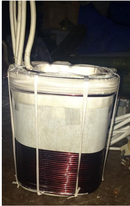
Figura 18 Aislamiento del bobinado primario
