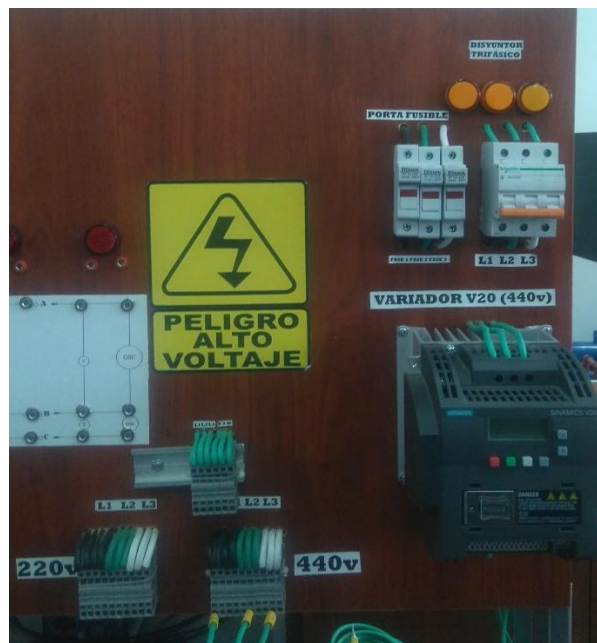
Figura 27 Sección de elementos de 440V
