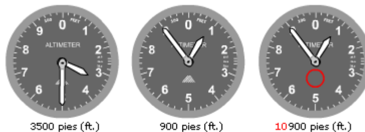
Figura 9: Lectura del altímetro de dos agujas Fuente: (Muñoz, Instrumentación)
