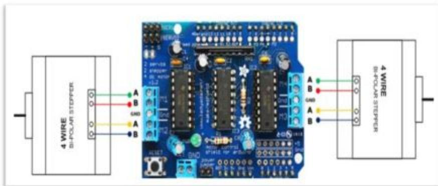
**Figura 23** Motor Shield I293d con los motores paso a paso
