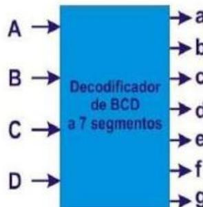
**Figura 6** Decodificador de BCD 7 segmentos
