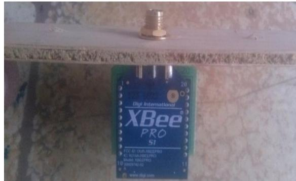
Figura 35 Conexión del módulo XBee Pro S1
