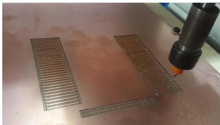
Figura No. 195 Programa de drilling en funcionamiento.
