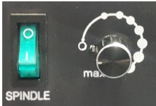
Figura No. 187 Disminuir la velocidad y apagar el Spindle.
