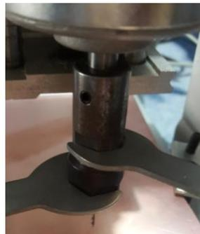
**Figura No. 287** Con las herramientas asegurarla broca de 0,8mm.
