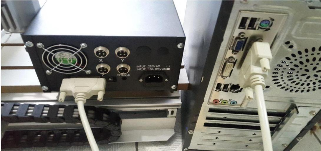
Figura No. 166 Conexión de la CNC con el computador.
