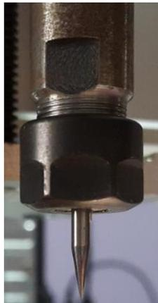
**Figura No. 79 Para el Engrava miento de pistas del circuito electrónico se coloca una punta cónica de 20°.**
