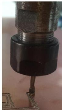
**Figura No. 298** Fijar la punta a -0.5 mm de la placa de baquelita.
