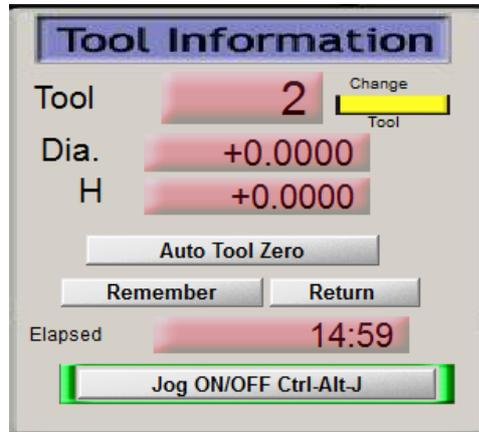
Figura No. 196 Pide insertar la herramienta dos que es la cortadora.
