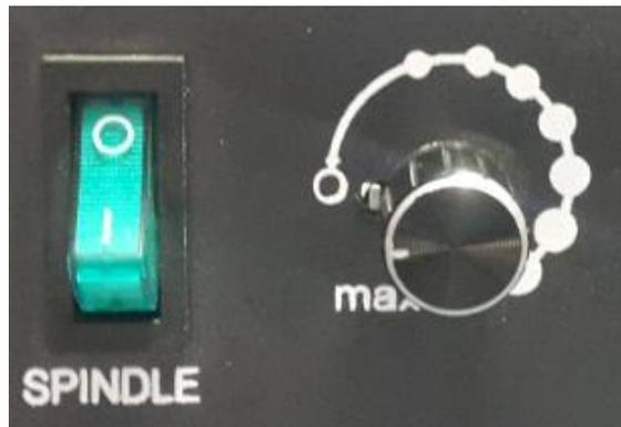
Figura No. 100 Disminuir la velocidad y apagar el Spindle.
