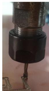
**Figura No. 201** Fijar la punta a -0.5 mm de la placa de baquelita
