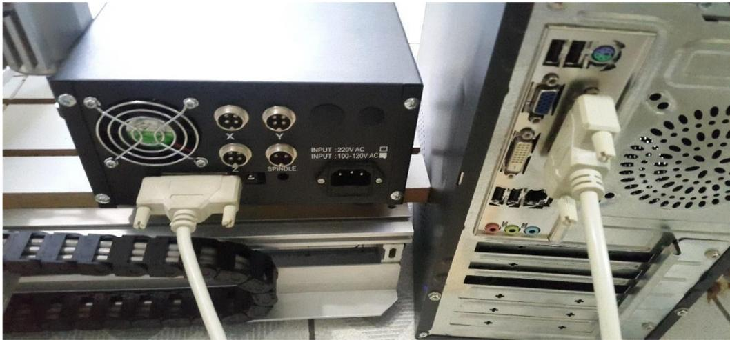
Figura No. 263 Conexión de la CNC con el computador.
