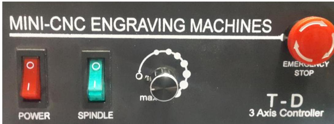
Figura No. 269 POWER interruptor para encender la maquina CNC.
