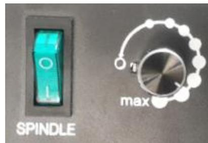
**Figura No. 86 Encender interruptor Spindle y generar velocidad media al encoder.**
