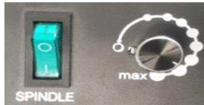
**Figura No. 280 Encender interruptor Spindle y generar velocidad media al encoder.**
