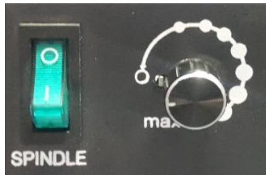
Figura No. 110 Reducir la velocidad del encoder y apagar el spindle.
