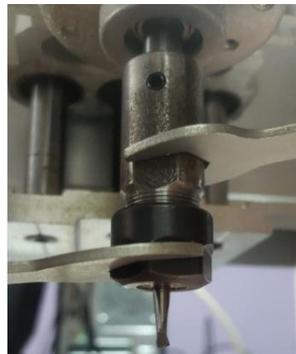
**Figura No. 200** Con la ayuda de las herramientas asegurar la cortadora.
