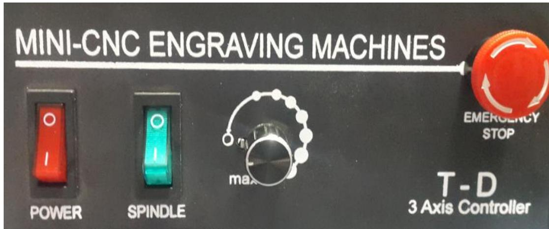
Figura No. 75 POWER interruptor para encender la máquina CNC.
