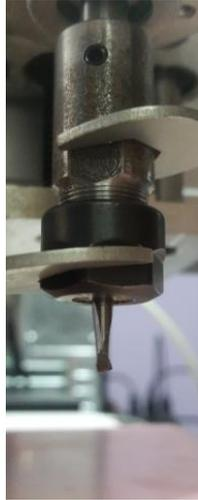
**Figura No. 199** Movimiento en el eje Z para poder desmontar herramienta 3 e instalar la herramienta 2.
