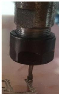
**Figura No. 104** Fijar la punta a -0.5 mm de la placa de baquelita.
