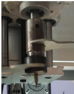
Figura No. 274 Con las herramientas se ajusta la punta cónica de 20°.
