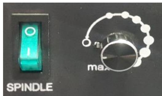
Figura No. 207 Reducir la velocidad del encoder y apagar el spindle.
