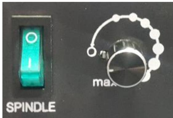
Figura No. 197 Disminuir la velocidad y apagar el Spindle.
