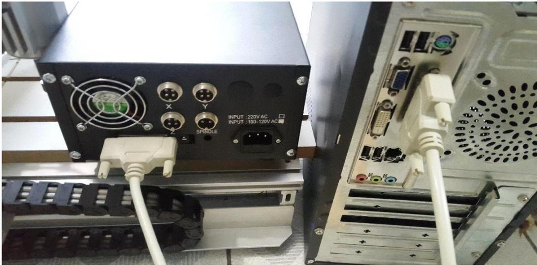
Figura No. 69 Conexión de la CNC con el computador.
