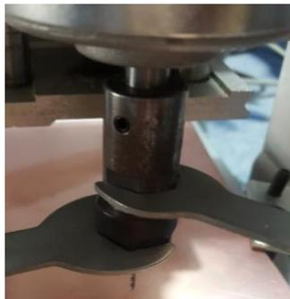
**Figura No. 93 Con las herramientas asegurar la broca de 0,8mm.**
