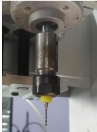
**Figura No. 286** Movimiento en el eje Z para poder desmontar herramienta 1 e instalar la herramienta 3.
