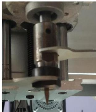
Figura No. 177 Con las herramientas se ajusta la punta cónica de 20°.
