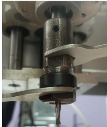
**Figura No. 103** Con la ayuda de las herramientas asegurar la cortadora.
