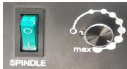
**Figura No. 183 Encender interruptor Spindle y generar velocidad media al encoder.**
