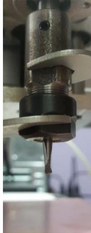
**Figura No. 296** Movimiento en el eje Z para poder desmontar herramienta 3 e instalar la herramienta 2.
