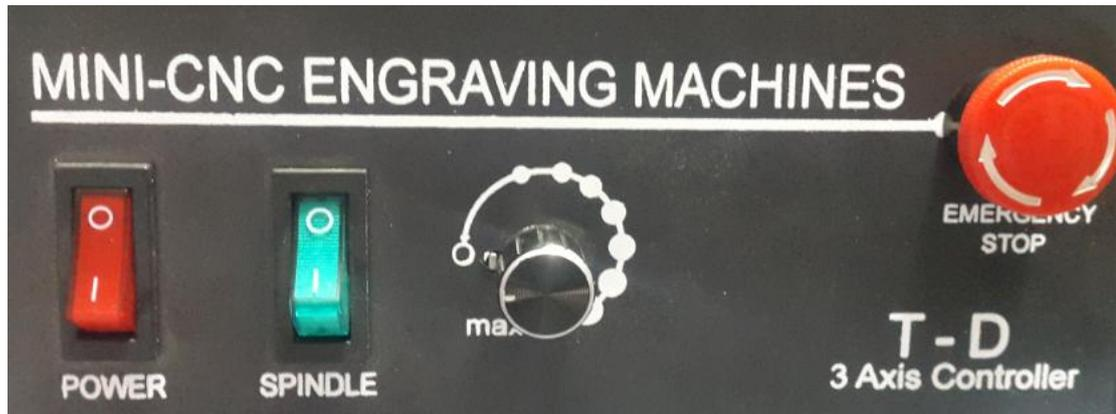
Figura No. 172 POWER interruptor para encender la máquina CNC
