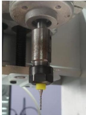
**Figura No. 189** Movimiento en el eje Z para poder desmontar herramienta 1 e instalar la herramienta 3.
