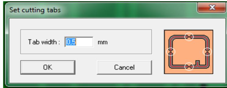
Figura No. 57 El valor en el cual no se cortara la placa de baquelita.
