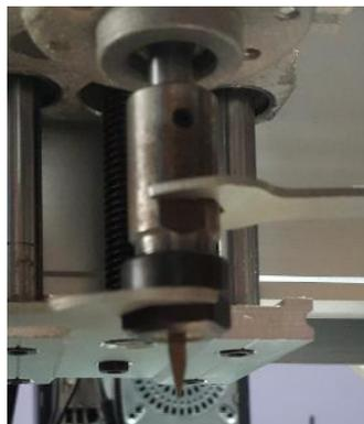
**Figura No. 80 Con las herramientas se ajusta la punta cónica de 20°.**
