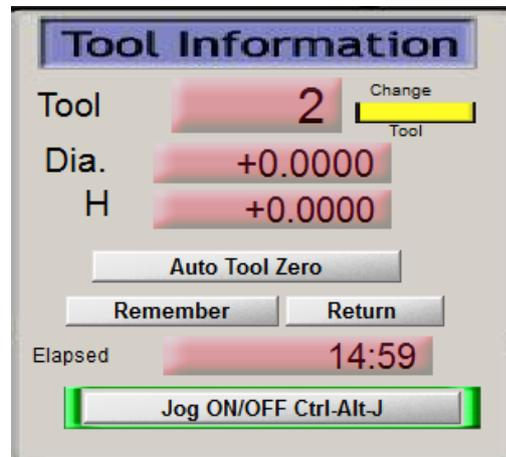
Figura No. 99 Pide insertar la herramienta dos que es la cortadora.
