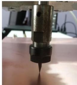
Figura No. 82 La punta cónica debe estar a 1mm de la placa de baquelita.
