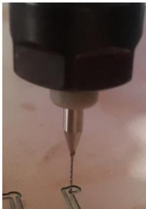
**Figura No. 191** Fijar la punta a -0.5 mm de la placa de baquelita.
