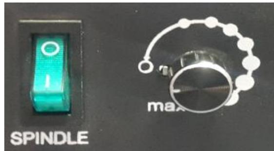
Figura No. 294 Disminuir la velocidad y apagar el Spindle.
