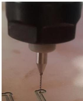
**Figura No. 94 Fijar la punta a -0.5 mm de la placa de baquelita.**
