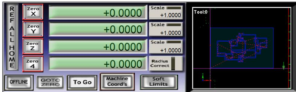
Figura No. 81 Para fijar la punta cónica solo debe existir movimiento en el eje z.
