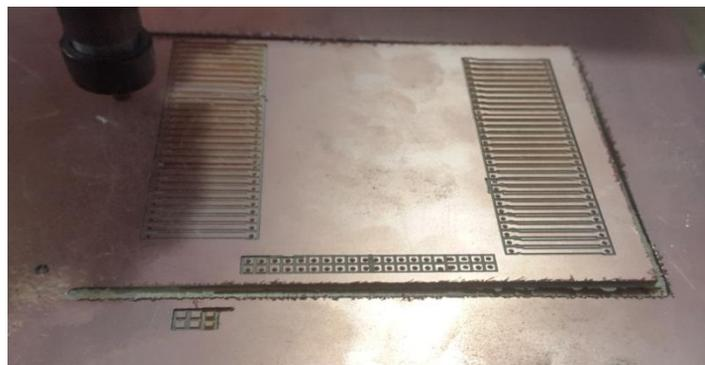
Figura No. 205 Programa de cortar en funcionamiento.
