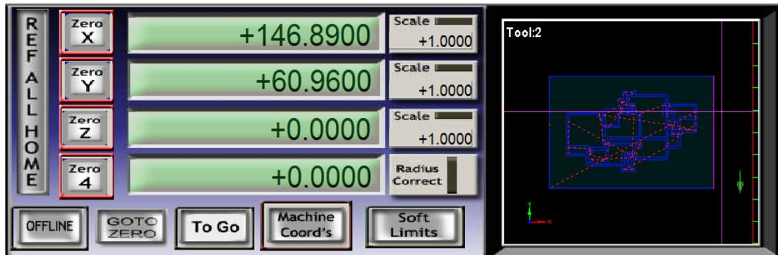
Figura No. 105 Fijar ZERO Z cuando la punta de la cortadora este a -0,5mm y no modificar ZERO X y ZERO Y, después levantar un poco el eje Z.
