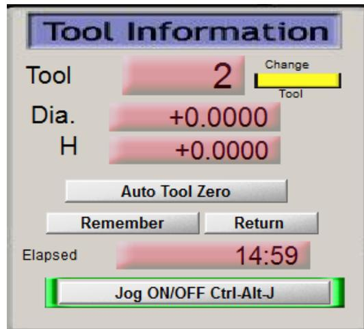
Figura No. 293 Pide insertar la herramienta dos que es la cortadora.
