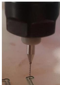
**Figura No. 288** Fijar la punta a -0.5 mm de la placa de baquelita.
