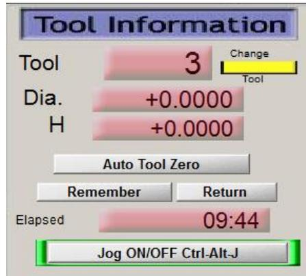
Figura No. 89 Insertar la herramienta 3 que es la broca de 0,8mm.
