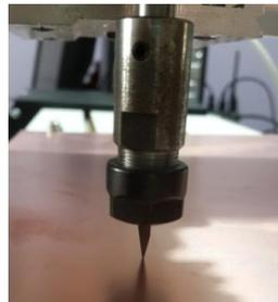
Figura No. 179 La punta cónica debe estar a 1mm de la placa de baquelita.
