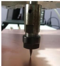
Figura No. 276 La punta cónica debe estar a 1mm de la placa de baquelita.
