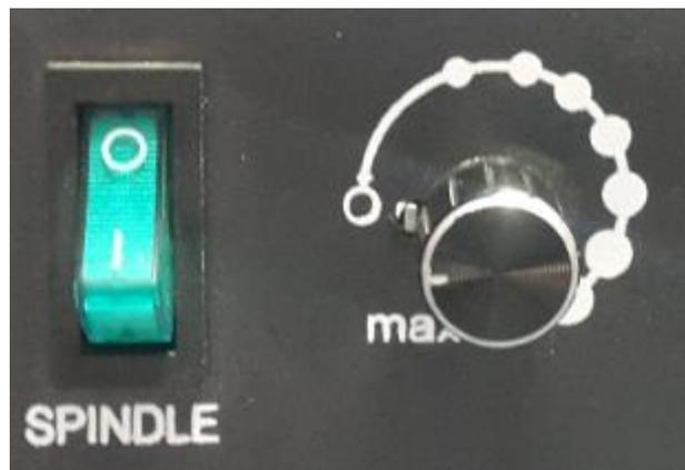
Figura No. 284 Disminuir la velocidad y apagar el Spindle.
