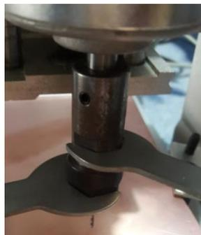
**Figura No. 190** Con las herramientas asegurarla broca de 0,8mm.
