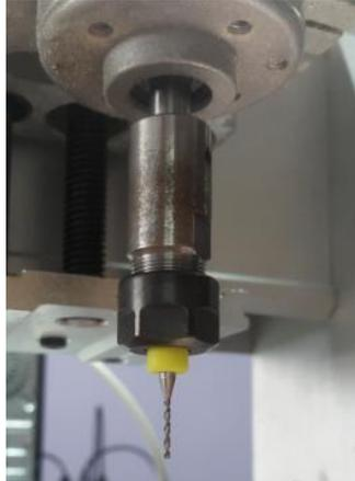
**Figura No. 92 Movimiento en el eje Z para poder desmontar herramienta 1 e instalar la herramienta 3.**
