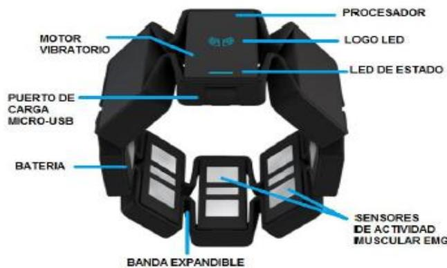
**Figura 7 Componentes del Dispositivo Myo**
