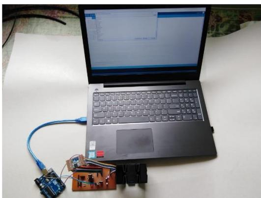
**Figura 54 Prueba de conexión entre arduino Uno y Brazalete Myo**
