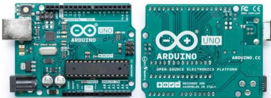
**Figura 10 Placa Arduino uno**
