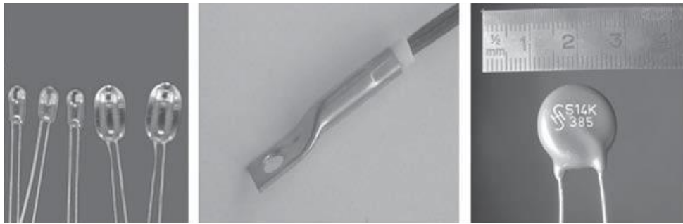
Figura 26 Termistores NTC y PTC
