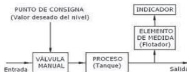
Figura 33 Sistema de control de lazo abierto
