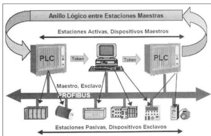
**Figura 12 Métodos de transmisión de datos en una red industrial**
