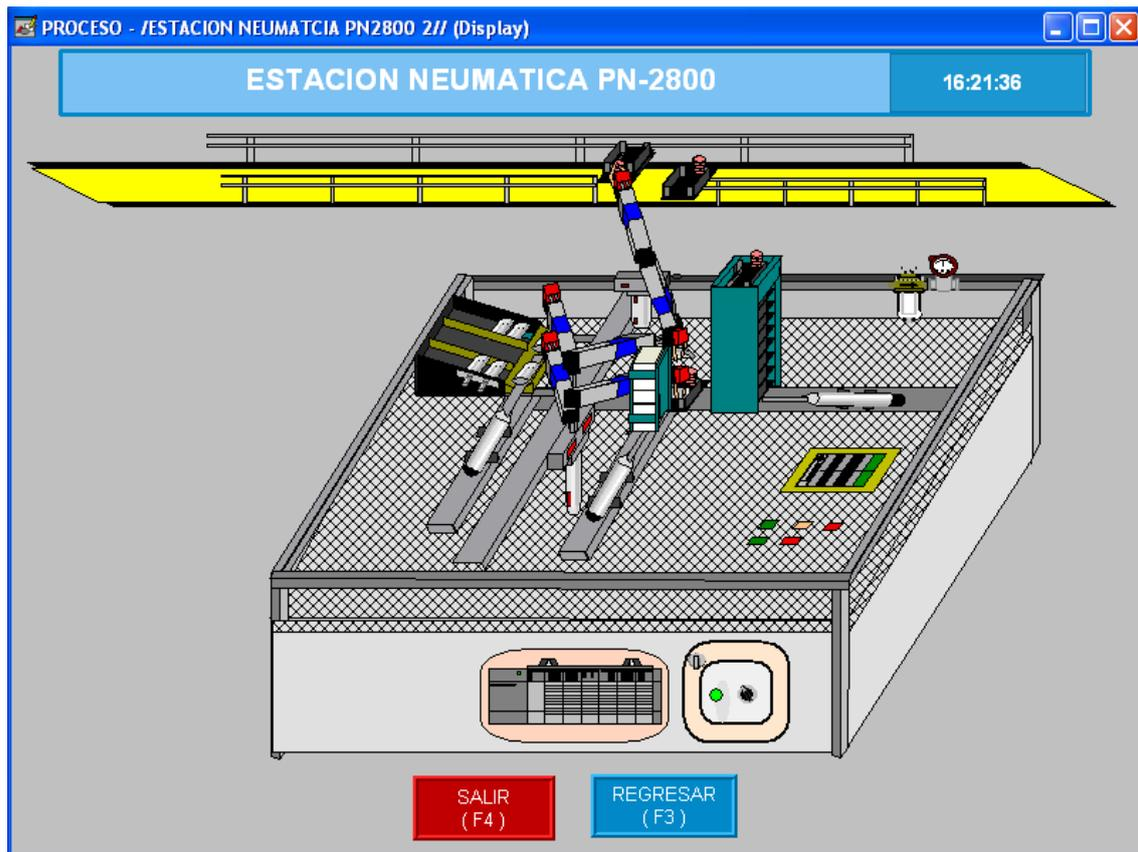
**Figura. 3.76 Pantalla Animación de Proceso HMI de Estación Neumática PN-2800**
