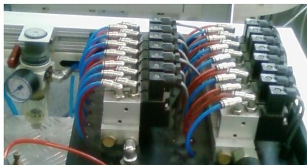
**Figura. 4.9 Sección Electroválvulas**
