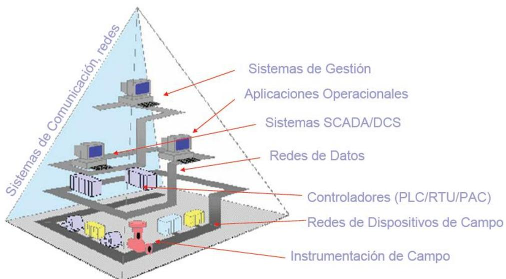
Figura.1.2. Sistema de Comunicaciones en la Pirámide de Automatización.
