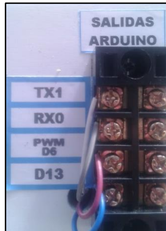
Figura 18 Terminales de salida del Arduino
