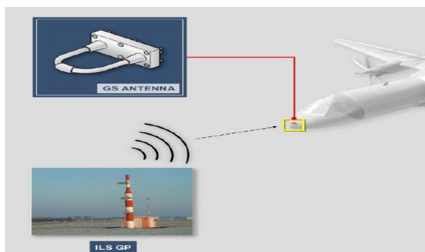
Figura 9. Antena Glide Slope. Fuente: (AIRBUS MILITARY, 2017)
