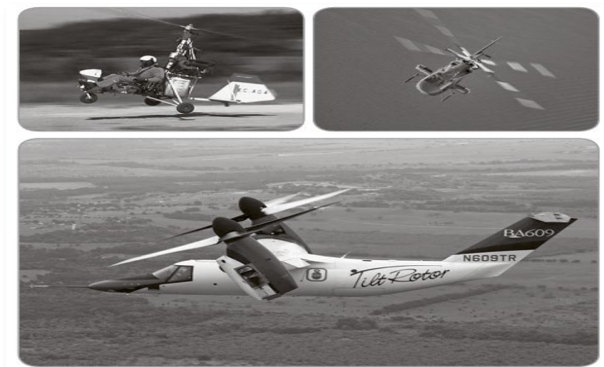
Figura 2. Alas rotatorias (autogiro, helicóptero y tilt rotor).
