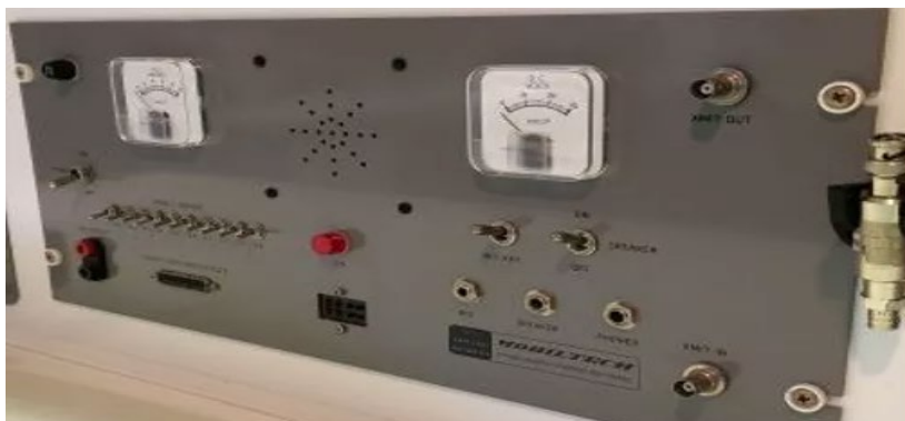
Figura 20. GP-6000 Test Panel. Fuente: (Avionics, s.f.)
