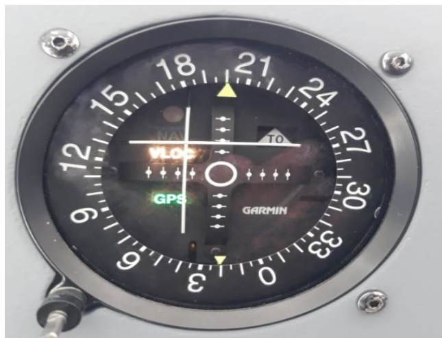
Figura 48. Encendido GI 106A
