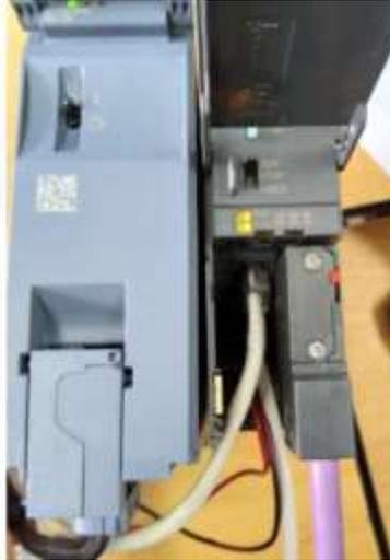
**Figura 48.** Conexión red Profibus con PLC S7-300.
