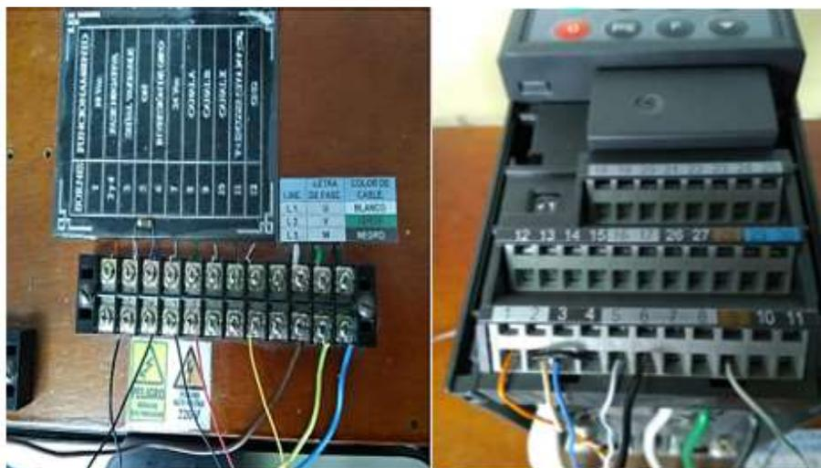
**Figura 46.** Conexiones entre el motor trifásico y variador de velocidad.
