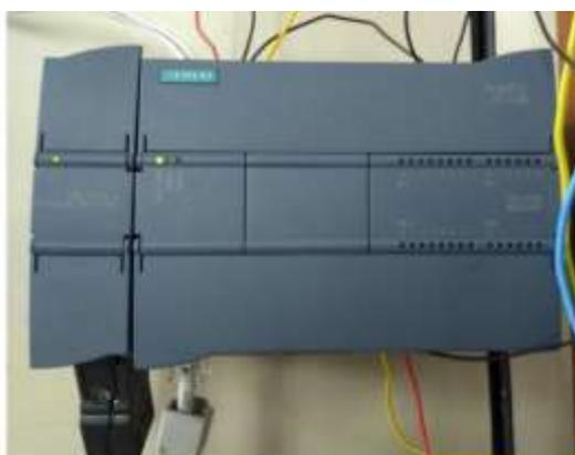
**Figura 47.** Conexión de red Profibus con el módulo CM 1242-5.
