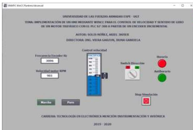
**Figura 50.** Obtención de datos sentido horario y control de velocidad.
