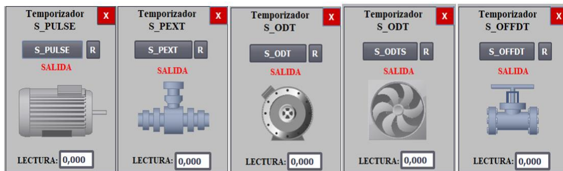
Figura 37. Imágenes emergentes para temporizadores en WinCC
