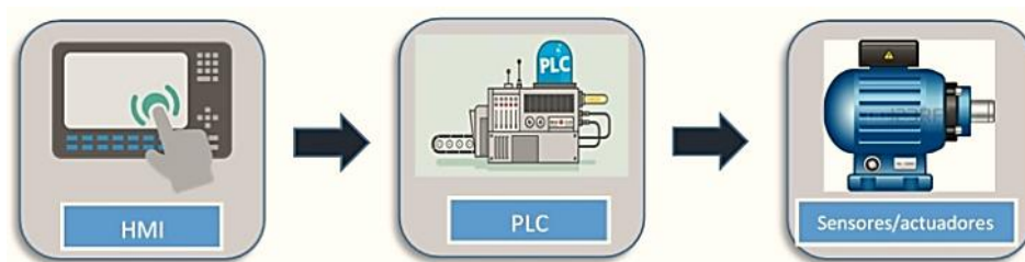
Figura 8. Diagrama de bloques de un HMI Fuente: (Zenteno, 2017)
