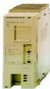
Figura 3. Fuente de alimentación para un PLC modular Simatic S5 Fuente: (Villajulca, 2015)
