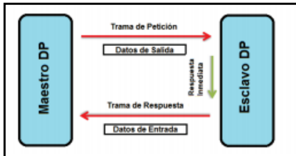
Figura 12 Principio de transferencia de datos.
