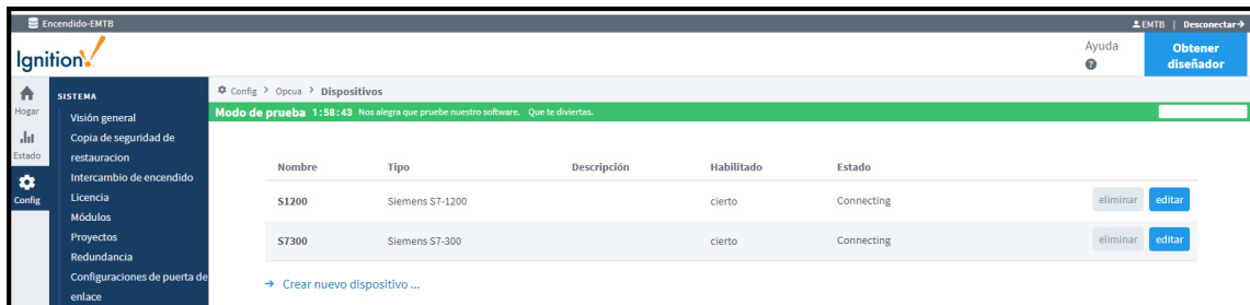
Figura 57 Creación de un nuevo dispositivo para establecer la comunicación del HMI con el S7-300 CPU 317-2 PN/DP.
