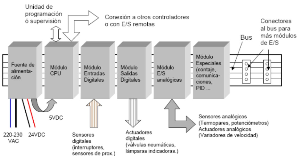
Estructura básica del PLC
