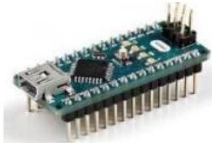
Nota: el gráfico muestra el módulo arduino Nano. Tomado de Cajamarca Velasco & Velasco Herrera, 2018.
