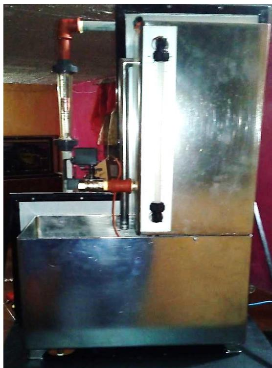
Nota: El gráfico muestra el montaje de los instrumentos de medición (rotámetro y mirilla de vidrio).
