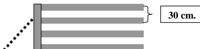
**ESQUEMA 1: Distribución y diámetros de los orificios en cada tubería de 30 m.**
