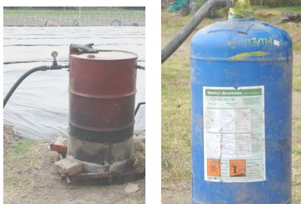
El dosificador es un barril de 50 galones que tiene un serpentín metálico en su interior, externamente solo se puede observar de este, la entrada, la cual se le conecta al tanque de bromuro, y la salida, que posee un manómetro para controlar la presión que no debe exceder de los 30 psi.
