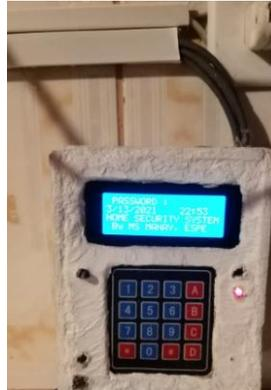
*Nota:* La figura muestra la conexión del LCD, teclado y luces indicadoras hacia el arduino.
