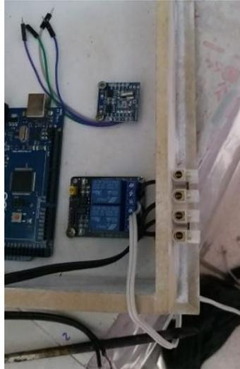
*Nota:* La figura muestra la conexión de las salidas del módulo de relés a borneras.
