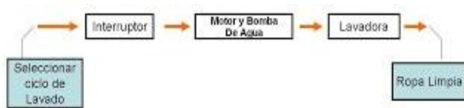
*Nota:* La figura representa el ciclo de lavado que es un ejemplo de un sistema de control de lazo abierto, debido a que no se controla la señal de salida. Recuperado de (*Sistemas de control - Ismael Robótica 4º*, s. f.).
