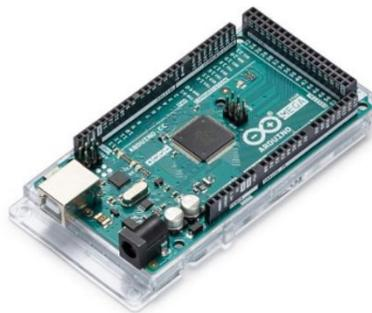
*Nota:* En la figura se muestra la placa de hardware libre Arduino MEGA 2560. Tomado de (Arduino, 2021).
