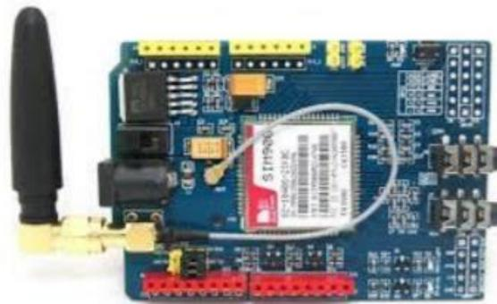
*Nota:* La figura muestra el módulo SIM 900, tarjeta de comunicación inalámbrica por lo que es similar a un teléfono móvil al momento de realizar llamadas y enviar SMS.
