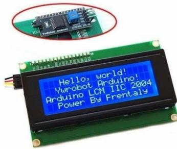
*Nota:* En la figura se muestra una pantalla LCD 20x4 con un módulo I2C incluido. Tomado de (C&D Technologia, 2021)
