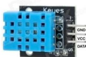
*Nota:* La figura muestra el módulo de temperatura y humedad DTH11 utilizado para monitorear las variables físicas de un invernadero. Tomado de (HallRoad, 2021).
