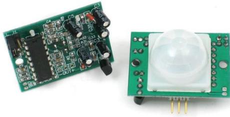
*Nota:* La figura muestra la vista frontal y posterior de un sensor PIR. Tomado de (Othar, 2021)
