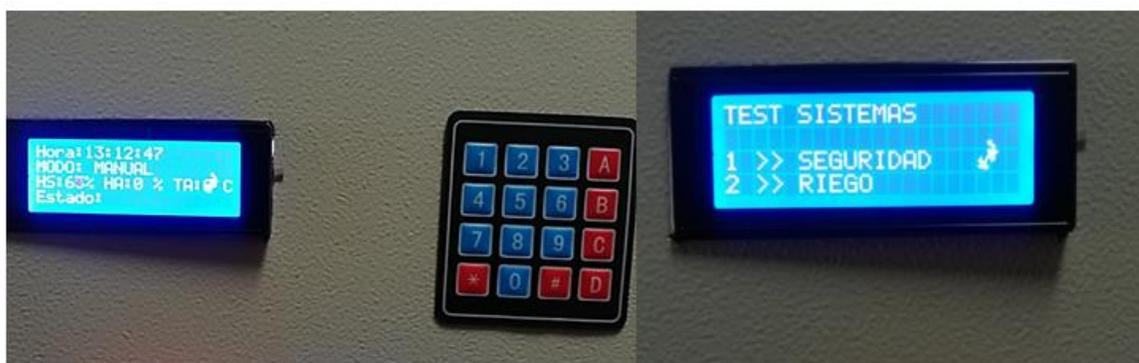
*Nota:* a) La figura muestra el interfaz de inicio donde se muestra los datos de los sensores de temperatura y humedad. b) Interfaz para realizar el test del sistema.
