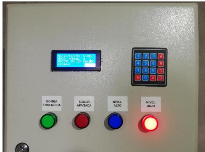
*Nota:* La figura muestra el tablero de control con el electronivel en estado bajo.
