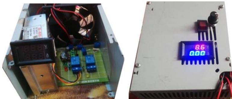
*Nota:* La figura muestra el montaje del UPS de D.C.
