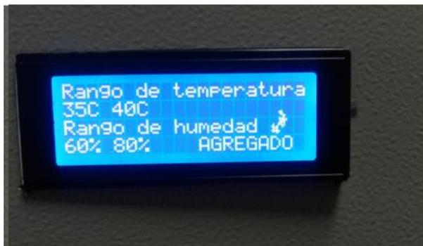
*Nota:* La figura muestra la configuración de rangos de temperatura ambiental y humedad de suelo para la activación de la electrobomba.
