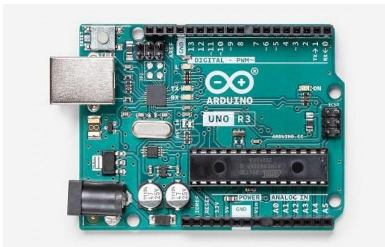
*Nota.* En la figura se muestra el Arduino UNO. Tomado de (Arduino, 2021)
