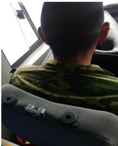
*Nota.* En la figura se muestra la ubicación del sensor en la cabecera del asiento del conductor en la cabina del automotor.
