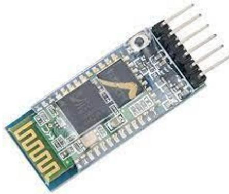
*Nota.* En la figura se muestra un bluetooth para Arduino HC06. Tomado de (Sum, 2021).
