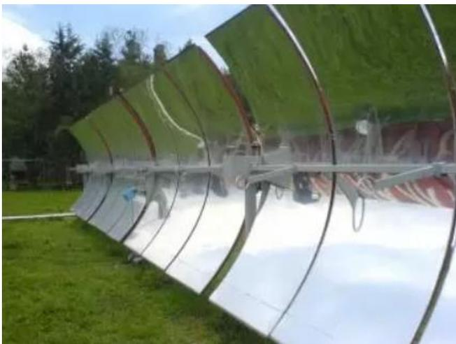
*Nota:* La ilustración muestra la forma de un colector solar de cilindro parabólico, tomado de (Planas, 2019)
