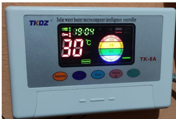
*Nota:* La fotografía muestra la pantalla del controlador en donde se aprecia el nivel de agua y la temperatura dentro del termotanque.
