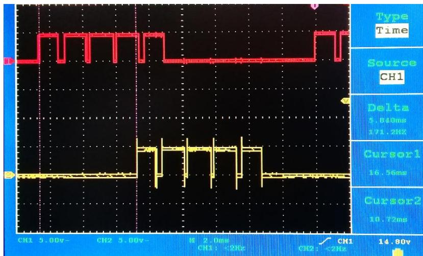
Nota: Los datos de medición de desfase se observan a la derecha de la imagen.
