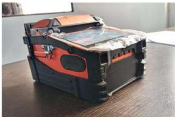
Nota. Muestra la máquina fusionadora *Signalfire AI-9* de la empresa E&E Ingenieros.
