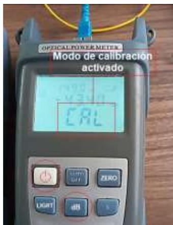
Nota. Muestra la activación del modo de calibración del *power meter*.
