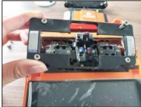
Nota. Muestra el soporte de la estructura interna de la empalmadora.
