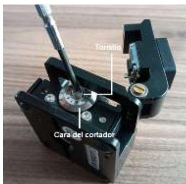
Nota. Muestra el cable de escala porque la cuchilla no tiene filo.
