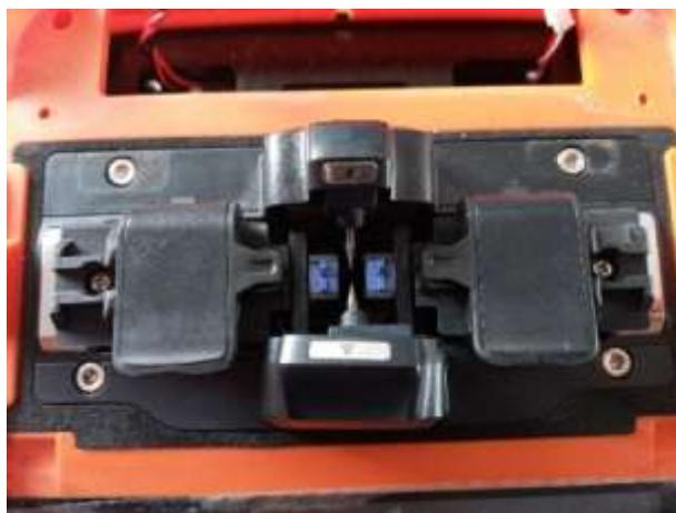
Nota. Muestra la ubicación de los electrodos en la fusionadora.
