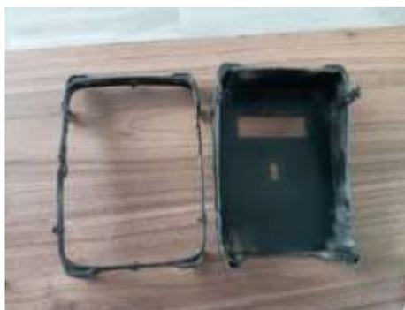
Nota. Muestra las protecciones de goma, están sujetas con tornillos de goma en diferentes puntos de la empalmadora.
