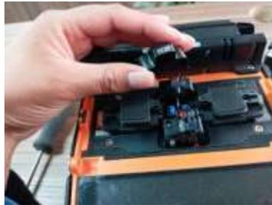
Nota. Muestra la manera de retirar la cubierta de cada electrodo.
