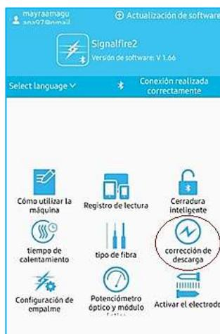
Nota. Muestra la selección de “corrección de descarga” o calibración del arco eléctrico.
