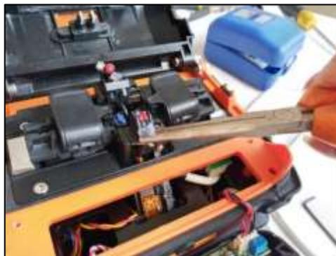
Nota. Muestra la forma de retirar los diodos LED con una pinza.
