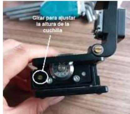
Nota. Muestra el tornillo que debe ser girado para ajustar la altura de la cuchilla.
