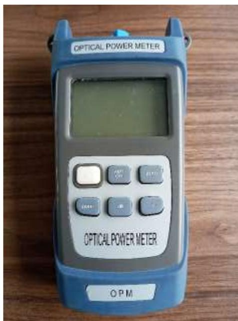
Nota. Muestra un medidor de potencia óptica modelo (H-OPM).
