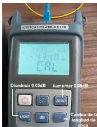
Nota. Muestra la manera de presionar las teclas para la calibración del equipo.
