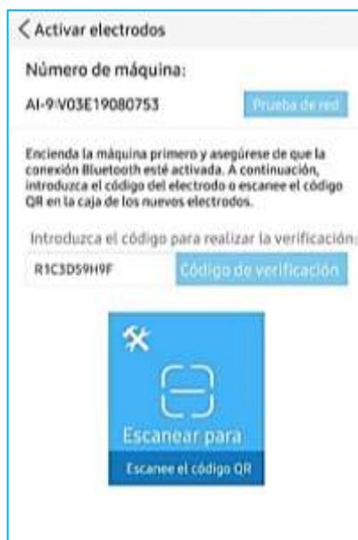
Nota. Muestra los datos de la empalmadora para la activación de electrodos mediante el *smartphone*.
