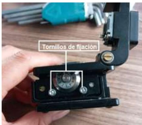
Nota. Muestra los tornillos que deben ser aflojados para el ajuste de cuchilla.
