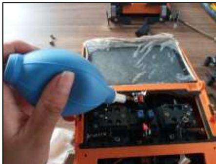
Nota. Muestra la limpieza interna de los circuitos de la fusionadora con un globo de goma de aire.
