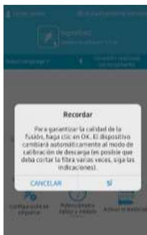
Nota. Muestra el mensaje para la calibración del arco eléctrico.
