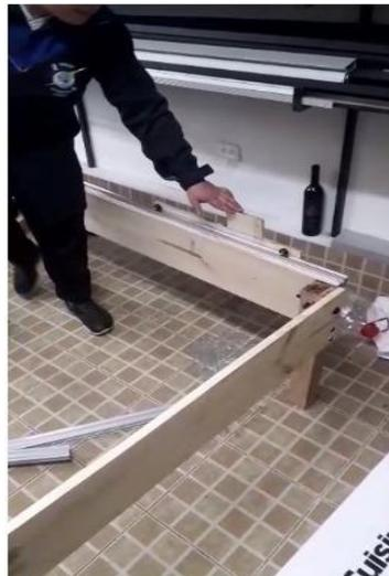
**Prueba 2:** La prueba se realizó con los mismos carros del eje longitudinal y en el eje transversal se utilizó una variante de acero galvanizado de 0.7 mm
