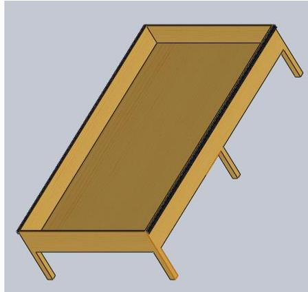
*Nota.* Caja con perfiles del eje longitudinal con dimensión de 20mm x 40mm x 3000mm, en esta caja se va a los elementos como tierra, la siembra y en los perfiles del eje longitudinal estarán perfiles como: superior y transversal con el carro del eje.
