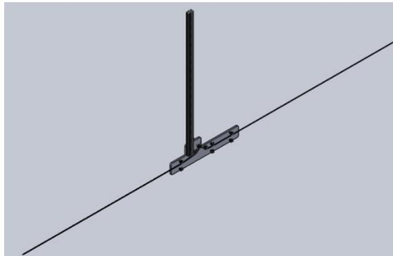
*Nota.* Carro del eje "y" con el eje superior del lado izquierdo con el eje superior del derecho, esta conformados por ocho ruedas con una medida de 2.5mm, diseño de manera "modo espejo".
