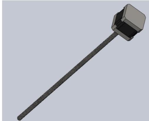
*Nota.* Motor con tornillo de potencia (tornillo sin fin), tiene una función de subir o bajar el eje "Z", este tornito tiene una rosa rectangular que se encuentra acoplada al motor Nema 17.
