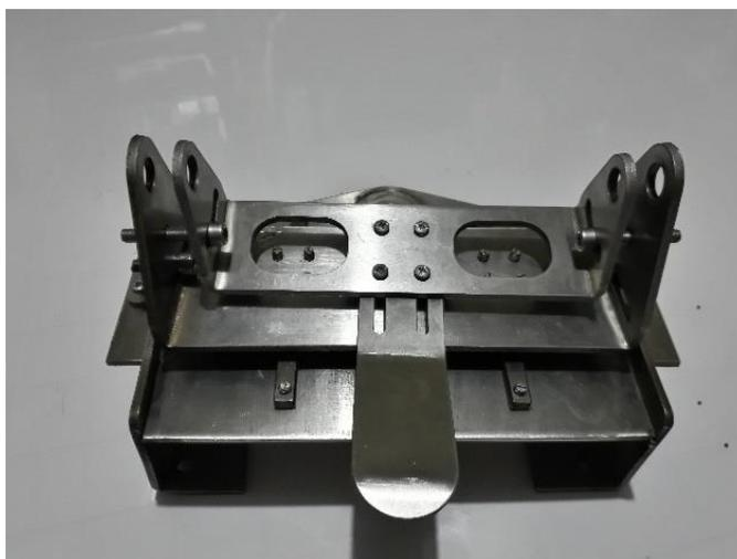
En la base de muñeca se coloca la almohadilla con cintas de velcro para ajustar la muñeca y se la sujeta mediante tuercas y tornillos M10 los mismos que servirán para unir a la base auxiliar tal como se ve en la figura 105.
