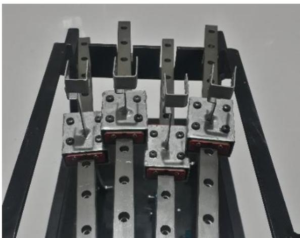
Acoplamiento de las guías lineales a la estructura base y a la unión del patín y los soportes de los dedos, la instalación del riel se realiza con tuercas y pernos M3 para
