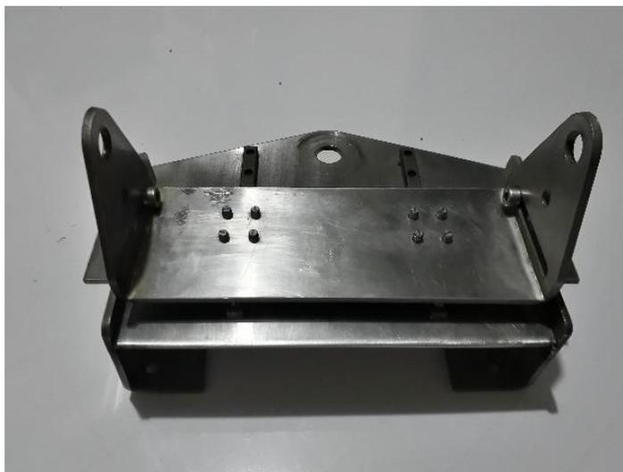
En la base auxiliar se procede al ensamble de la lengüeta mediante tuercas y pernos M3 como se ve en la figura 103, terminado este acople se procede al montaje sobre la base secundaria mediante tuercas y pernos M4 como se ve en la figura 104.
