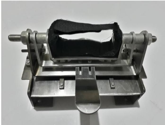
Una vez ensamblado el soporte de la muñeca se procede a la colocación del extensor del antebrazo el cual está compuesto por dos piezas que están fabricadas con tubos cuadrados vacíos de acero ASTM A500 los cuales van sujetos a la base principal mediante tuercas y pernos M12 como se ve en la figura 106.
