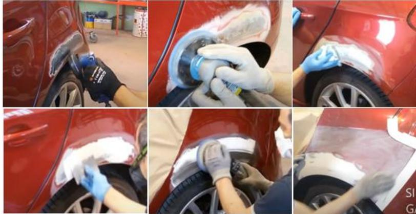
*Nota.* En la imagen se puede identificar un proceso de preparación de superficies.
