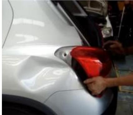
*Nota.* En la figura se muestra el proceso de desmontaje de piezas necesarias para realizar el trabajo de reparación.
