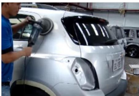
*Nota.* Luego de secado, se procede a realizar un pulido final para perfeccionar el acabado.
