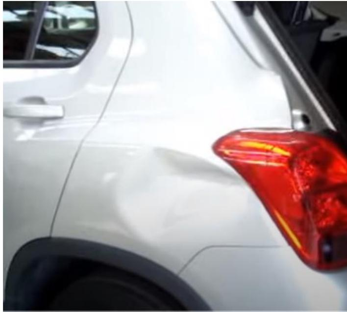
*Nota.* La figura muestra una abolladura del guardafango posterior izquierdo.
