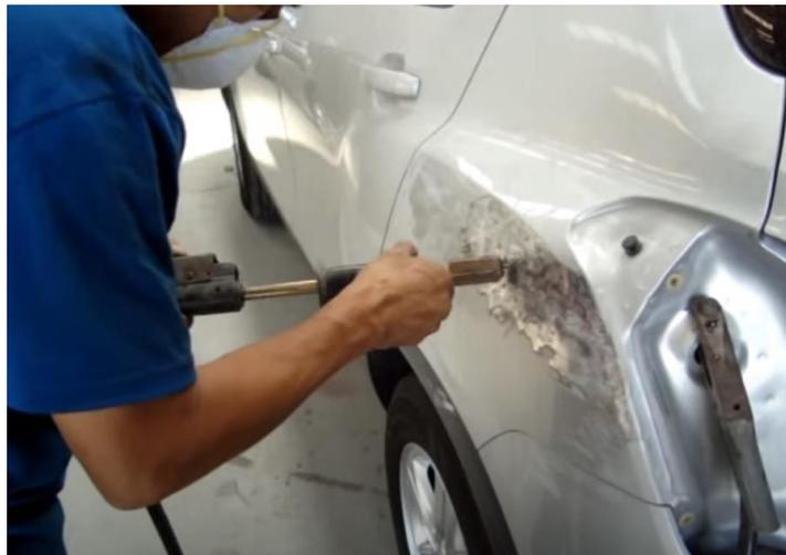
*Nota.* Se utiliza un martillo de inercia para sacar las abolladuras puntuales.
