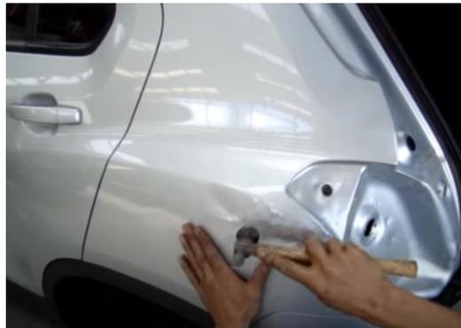
*Nota.* En la imagen se puede visualizar el proceso de enderezada con la técnica de martillo y sufridera.
