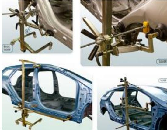
*Nota.* En el gráfico se puede visualizar enderezado de carrocería.
