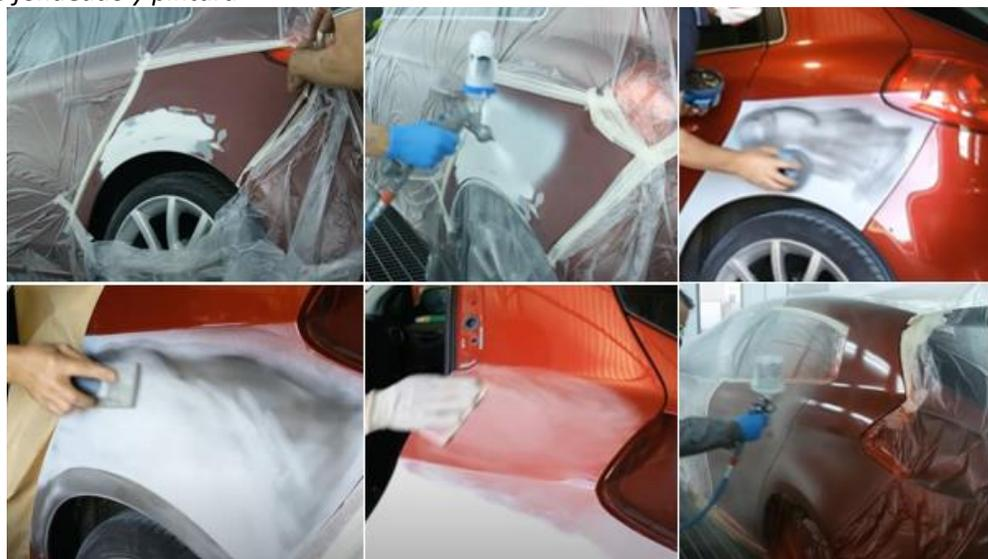
*Nota.* En la imagen se puede identificar un proceso de fondeado y aplicación de pintura.
