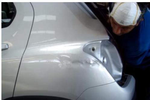
*Nota.* Proceso de desabollado por varilla, se acerca a la geometría original del guardafango.
