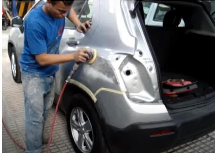
*Nota.* Se puede visualizar el proceso de lijado de daños.
