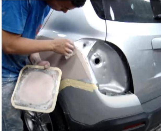
*Nota. Se observa el enmasillado, correspondiente al proceso de preparación de superficies.*
