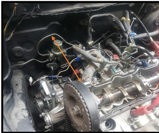
En las dimensiones medidas desde el block sin el múltiple de admisión existe una distancia de 28 cm hasta el muro de fuego, es una consideración que se debe tener al momento de dimensionar el colector debido a que se lo sobredimensiona se llegaría a tener inconvenientes al momento de instalarlo, se debe tomar en cuenta que hay que dejar un espacio de seguridad para que el captador de aire no quede pegado a la pared posterior y tenga un déficit al momento de conducir el aire hacia el colector.
