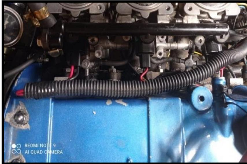
**3.14.6.9 Módulo De Encendido.** Se utilizó el mismo módulo de encendido que utiliza el distribuidor, pero para poder controlar el encendido y avance se quitó la señal de la bobina captadora y se puso un cable blanco que viene de la computadora denominado IGN el cual brinda una señal positiva de 0 a 5 V lo suficiente para generar la chispa en la bobina, con ello se controla el encendido desde la computadora.
