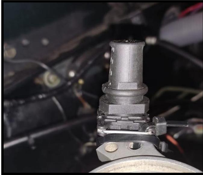
**3.14.6.8 Inyectores.** Los inyectores vienen conjuntamente con los ITB, y constan con dos terminales los cuales van ir conectados de la siguiente manera: un cable viene directamente de la fusiblera con un valor de 12 v, y el cable restante es el control de masa que brinda la computadora, que en el caso de la megasquirt es un cable de color verde denominado inyección 1.
