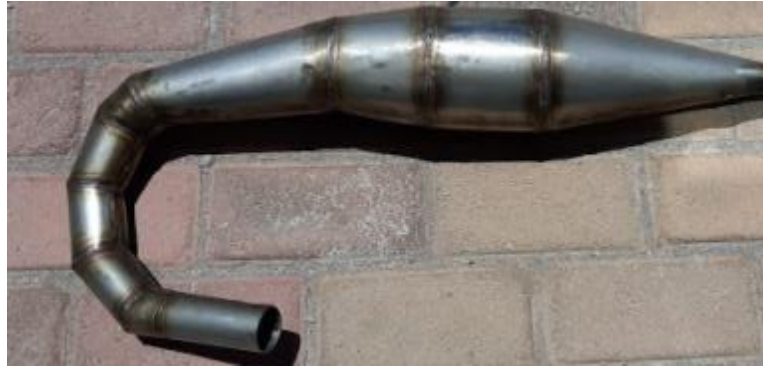
Tubo de Escape Tuned Pipe Soldado
