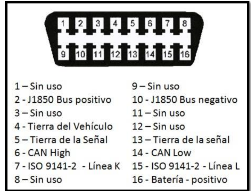
Terminales del conector OBDII
