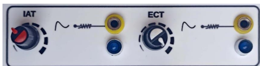
Mandos y tomas de medición de los sensores IAT y ECT
