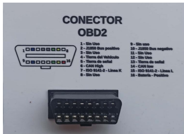
Designación de pines del conector OBD2
