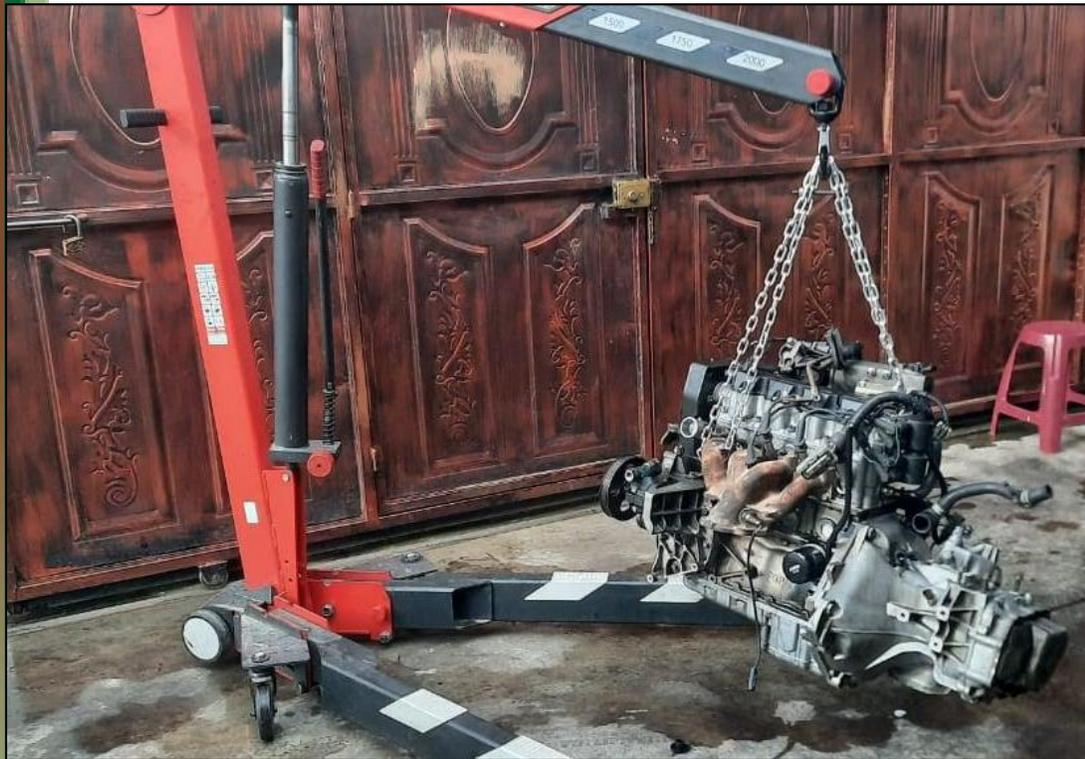
Una vez que el motor ha sido armado en su totalidad, se procede al montaje en el vehículo con la ayuda de una pluma de sujeción y teniendo en cuenta todas las medidas de seguridad para evitar daños en el motor como tal y sobre todo preservar la integridad de los operarios.
