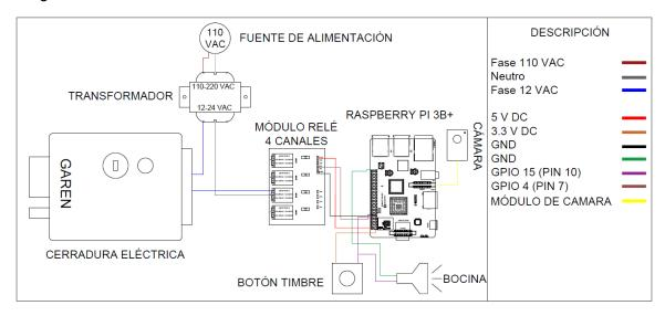
Nota: La figura representa el diagrama de conexiones del sistema automatizado con la respectiva descripción de los colores utilizados para representar las cables conductores y conexiones físicas.
