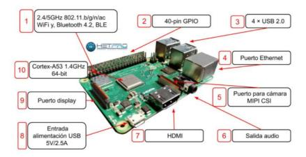
Nota. La figura representa los 10 elementos principales de una tarjeta embebida Raspberry Pi 3B+ en los que se destacan sus puertos, tipo de procesador y conexiones Wifi y Bluetooth. Tomado de HETPRO Herramientas Tecnológicas Profesionales por Dr. Rubén Estrada Marmolejo, 2021, Hetpro.
