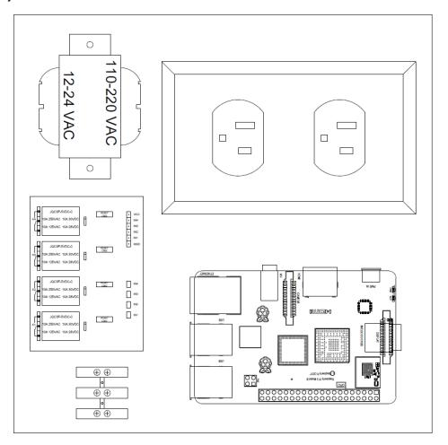
Nota. La figura representa el bosquejo para la distribución de los elementos electrónicos dentro del tablero.
