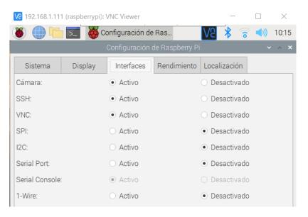
Nota. La figura representa las interfaces que posee una Raspberry Pi 3B+ en su configuración, aquí se pueden habilitar o deshabilitar protocolos de comunicación y activación o desactivación de puertos.
