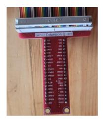
Nota. La figura representa un módulo de expansión de 40 pines GPIO de una Raspberry Pi 3B+ conectado a un bus de datos.
