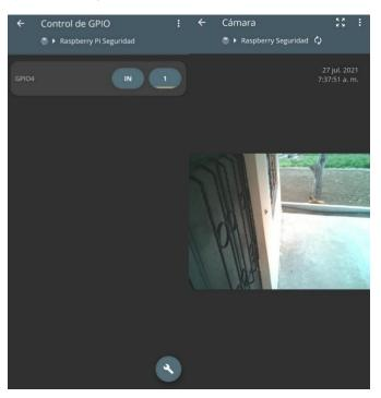
Nota. La figura representa la interfaz gráfica de la aplicación para el control del GPIO y monitoreo del módulo cámara de Raspberry Pi.
