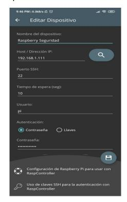
Nota. La figura representa la configuración y datos necesarios para establecer una conexión entre la aplicación móvil y la tarjeta Raspberry Pi 3B+.
