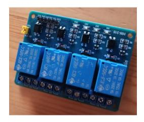
Nota. La figura representa un módulo relé de 4 canales con alimentación de 5 VDC modelo HW-316.
