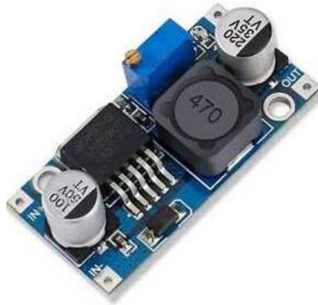
*Nota.* Modulo que permite regular el voltaje de salida dependiendo cuanto se necesite. Tomado de (Córdova, 2021)
