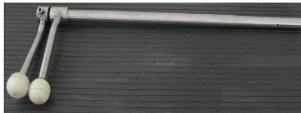
**Figura 5.22 Mandril para alinear tubo guía**
