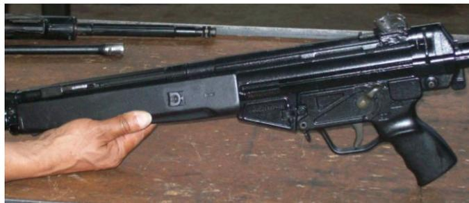
**Figura 1.3 Caja de Mecanismos**
