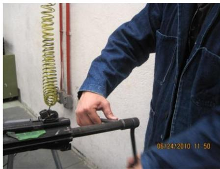
**Figura 5.21 Muestra cómo eliminar la abolladura con el mandril**
