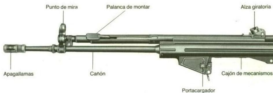
**Figura 2.3 Cajón de mecanismo con cañón, dispositivos de montar y puntería.**
