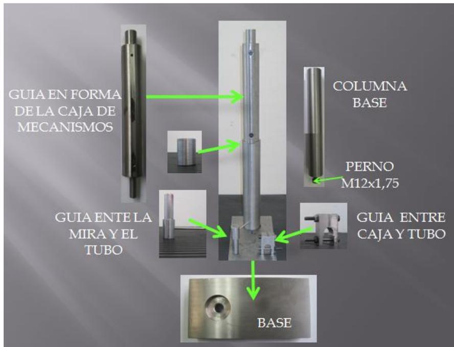
**Figura 4.16 Matriz Para El Ensamble De La Caja De Mecanismos – Tubo Cañón**
