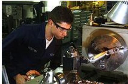
**Figura 2.39 Operario trabajando en un torno paralelo**
