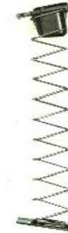
**Figura 2.15 Elevador con muelle elevador y chapa de seguridad**
