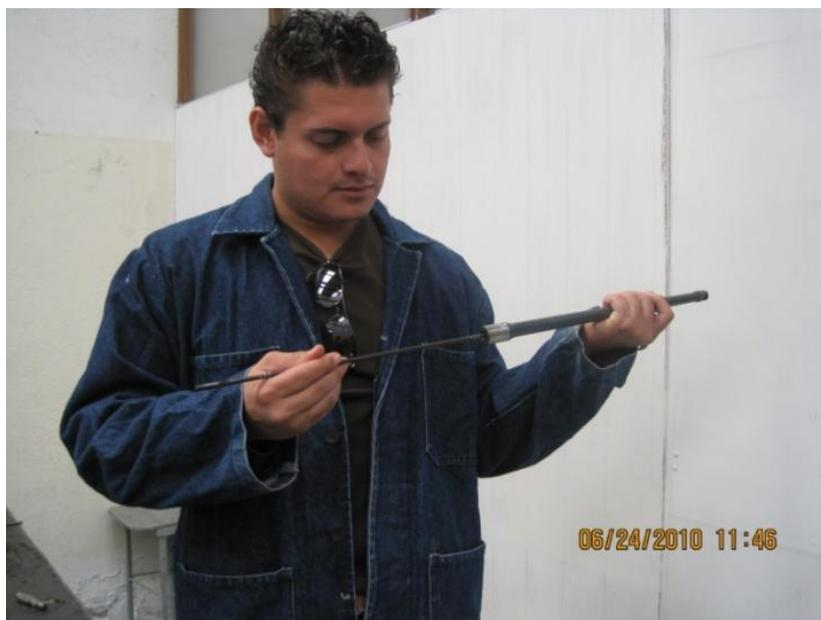
**Figura 5.3 Manera de comprobar el cilindro interno del tubo cañón parte trasera.**
