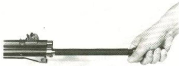
**Figura 5.7 Manera de introducir el calibre 'pasa' y de simetría en la caja de mecanismos y el tubo guía**
