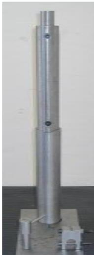
**Figura 5.30 Matriz de ensamble de la caja de mecanismos-tubo cañón**
