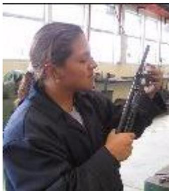
**Figura 5.31 Colocación de la guía del tubo cañón con la mira**
