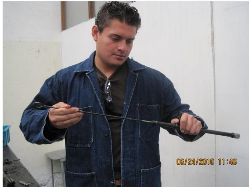
**Figura 5.2 Manera de comprobar el cilindro interno del tubo cañón parte delantera.**
