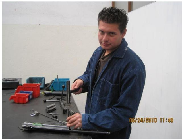
**Figura 5.12 Manera correcta de utilización de los botadores**
