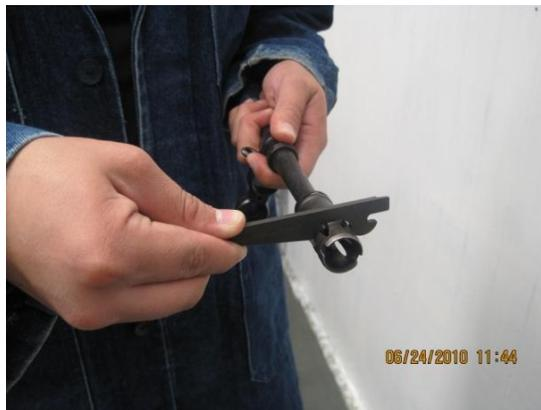
**Figura 5.16 Forma correcta de utilización de la herramienta cuando El apagallama se encuentra apretado**
