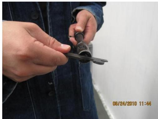
**Figura 5.17 Forma correcta de utilización de la herramienta cuando el apagallama no requiere mayor fuerza**
