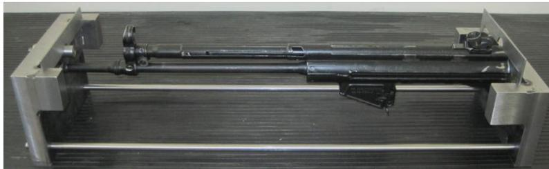
**Figura 5.32 Mecanismo de alineación de los elementos de puntería**
