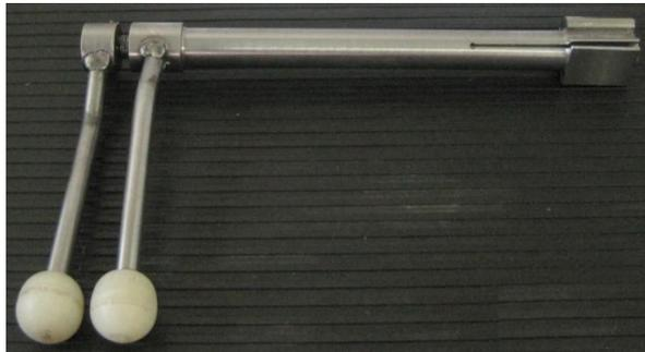
**Figura 5.19 Mandril para alinear caja de mecanismos**
