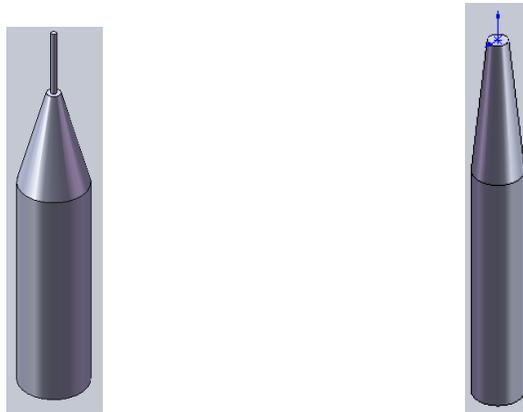
**Figura** ¡Error! No hay texto con el estilo especificado en el documento..**2 Botador Cilíndrico** **Figura** ¡Error! No hay texto con el estilo especificado en el documento..**3 Botador Cónico**
