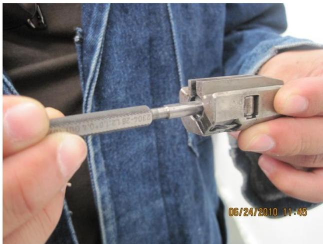
**Figura 5.5 Manera de ingresar el lado “pasa” del calibre**
