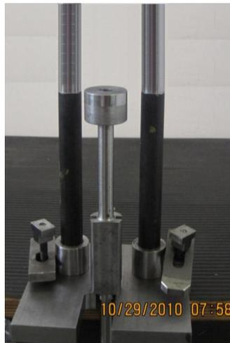
**Figura 5.25 Matriz de expulsión de la caja de mecanismos-tubo cañón**
