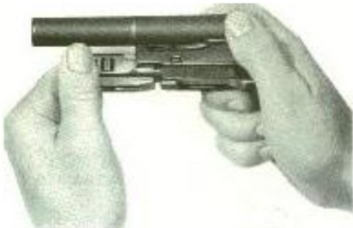
**Figura 2.30 Desmontar el conjunto del cierre**
