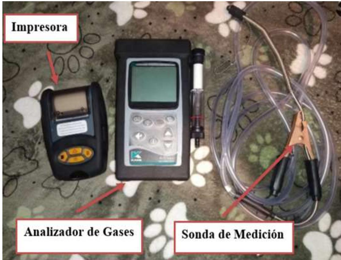
Tiempo de calentamiento menor a 2 minutos, comunicación a PC/ANDROID: Bluetooth – RS-232, memoria/ Data Logging: 500 TESTS, temperatura ambiente: 5 – 45 °C, humedad: 10 – 90% RH no condensada, temperatura Almacenamiento: 0 – 50 °C, fácil mantenimiento, control de velocidad de bomba.
