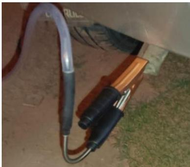
*Nota.* Conectando el analizador de gases portátil Kane al vehículo para la realización de las mediciones.
