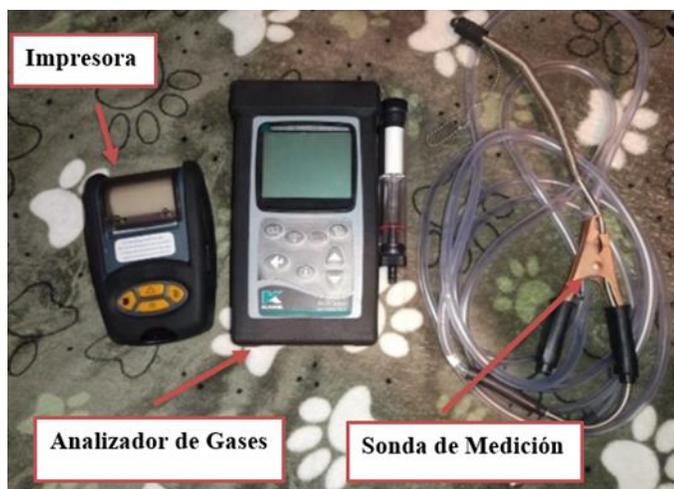
*Nota.* Aquí se puede observar el analizador de gases portátil Kane auto plus 4-2 elegido para realizar las mediciones.
