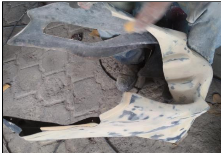
Figura 42. Proceso de masillado y lijado (lija #1800).
