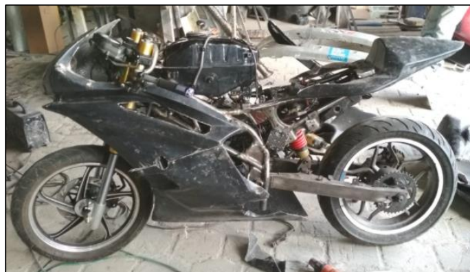
Figura 40. Entallado del carenado completo.
