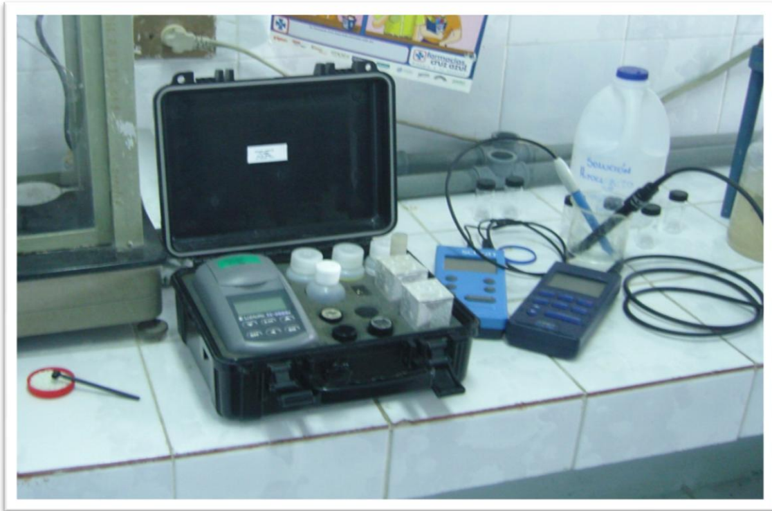
Medidores de parámetros físico químicos del agua
