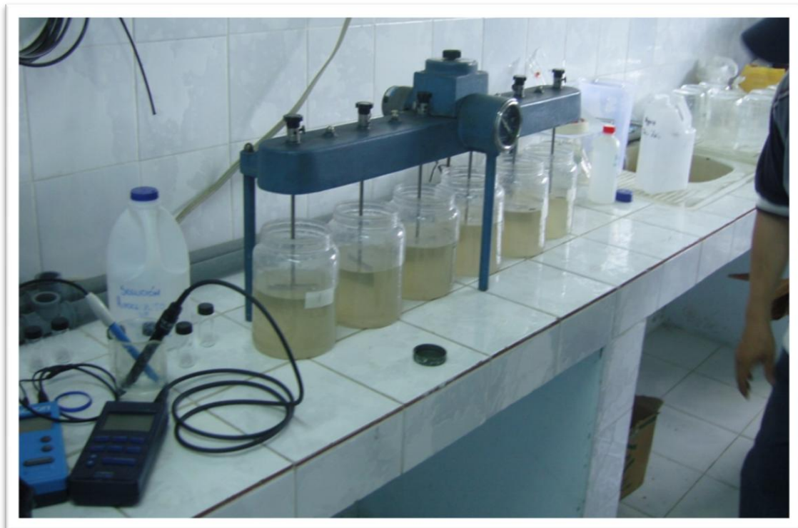
Prueba gradientes de floculación (Pruebas 4,5,6)
