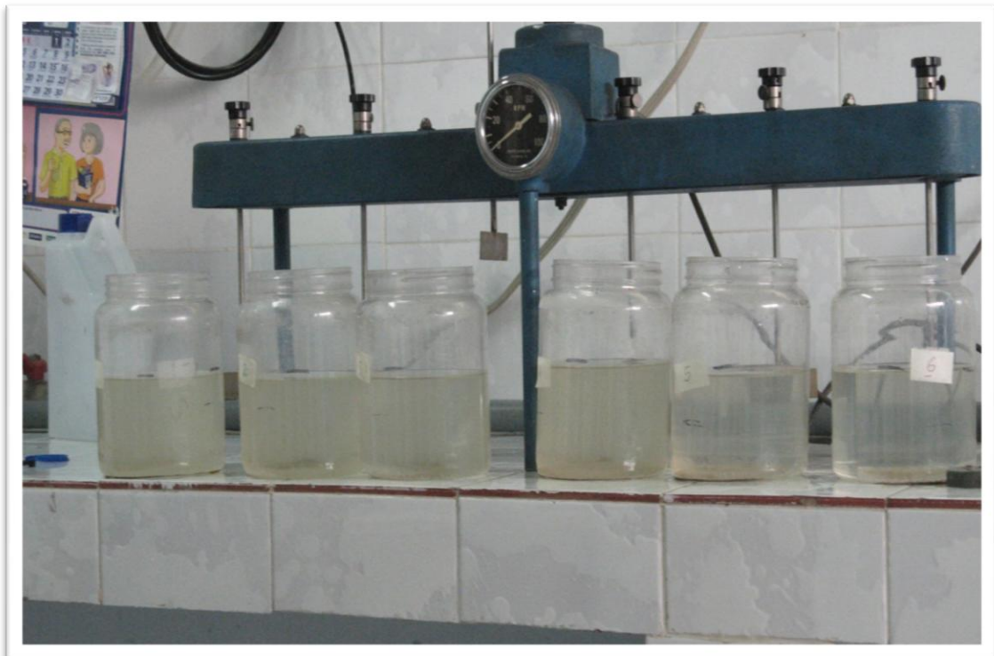
Muestras sedimentadas (Prueba 1)
