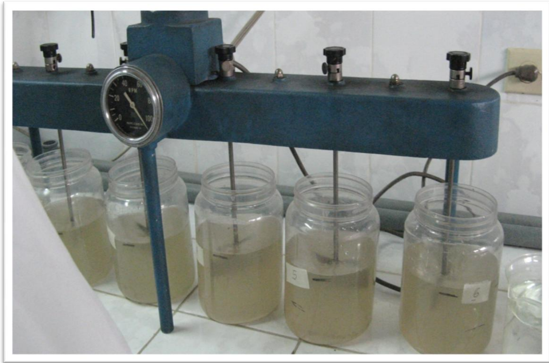
Dosis Óptima de Coagulante (Prueba 1)
