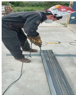
*Nota.* En la imagen se puede identificar como se perfora el material para darle las características desmontables a la estructura de la cabina.
