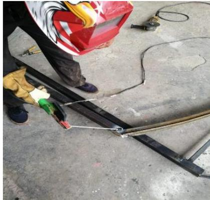
*Nota.* En la imagen se puede identificar como se realiza la suelda para poder levantar a la estructura de la cabina.
