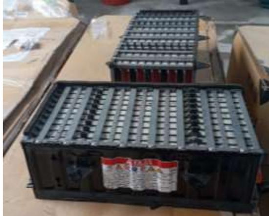
*Nota.* En la figura anterior se observa la batería de alto voltaje utilizadas para las respectivas pruebas en el banco de prueba.
