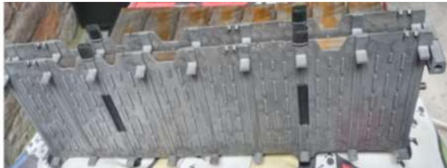
*Nota.* La imagen nos muestra el separador que tiene cada celda para que no exista contacto entre ellas
