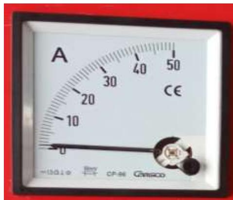
*Nota.* El amperímetro análogo será capaz de medir la corriente que pasa por el circuito tanto de carga como la de descarga.
