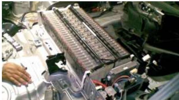
*Nota.* En la imagen se muestra una batería HV de la marca Toyota. Tomado de (Técnico Automotriz, 2014)
