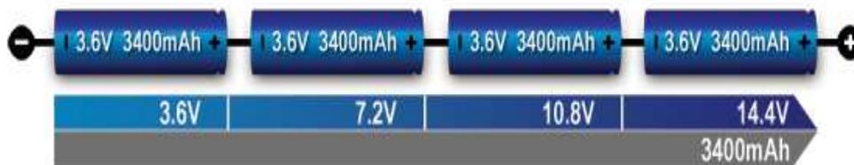
*Nota.* En la figura anterior se observa la conexión en serie de 4 baterías de litio en donde el voltaje se suma, pero la capacidad de los amperios/hora es el mismo. Tomado de (Pulido, 2018)
