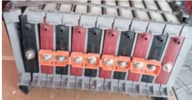
*Nota.* Podemos apreciar las lengüetas de conexión de la batería la que hace posible la suma de voltajes de cada celda.
