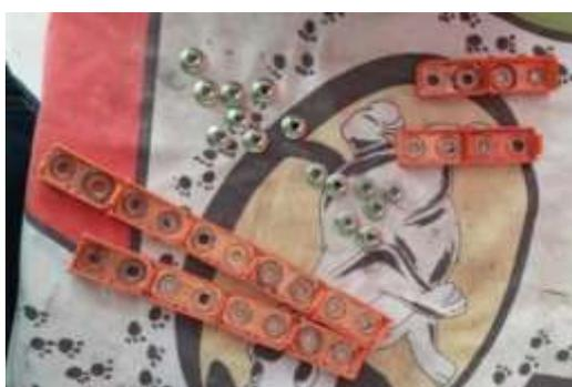
*Nota.* Limpieza de lengüetas para que no exista un falso contacto entre celdas.
