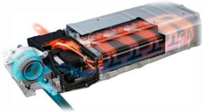
*Nota.* Podemos observar la circulación del calor por toda la batería y la ventilación de la misma la batería mostrada como ejemplo es de la marca Toyota Auris. Tomada de (Martos, 2018)
