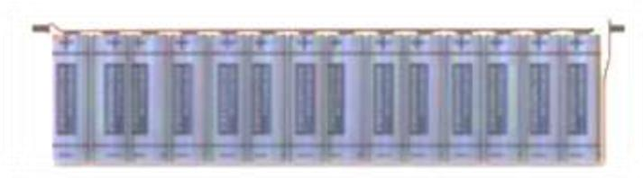
*Nota.* Podemos observar en esta imagen el interior de una celda simulada con pilas conectadas en serie para sumar el voltaje de cada una.
