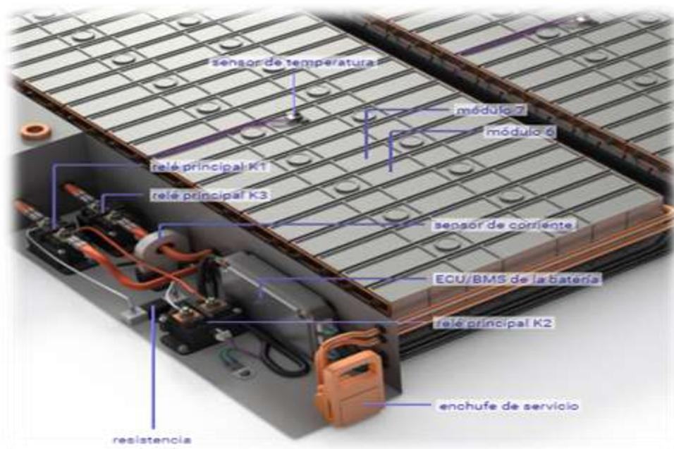
*Nota. La figura anterior se puede observar los respectivos componentes de la batería de alto voltaje con sus respectivos elementos.*
