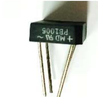
*Nota.* El puente de diodos será capaz de permitir la conversión de corriente alterna a corriente continua.
