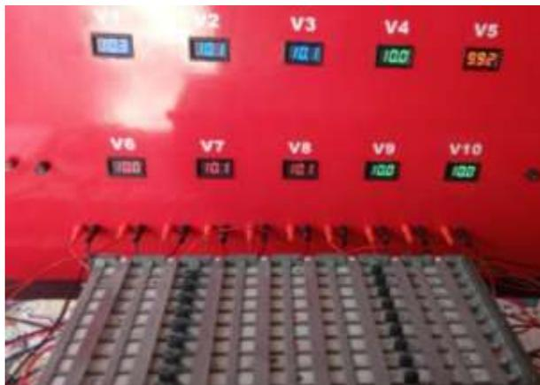
*Nota.* Aquí podemos observar las mediciones de cada celda con su respectiva conexión a cada voltímetro.
