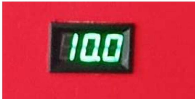
*Nota.* El voltímetro es de forma rectangular y de 3 dígitos con una capacidad de 30 v.
