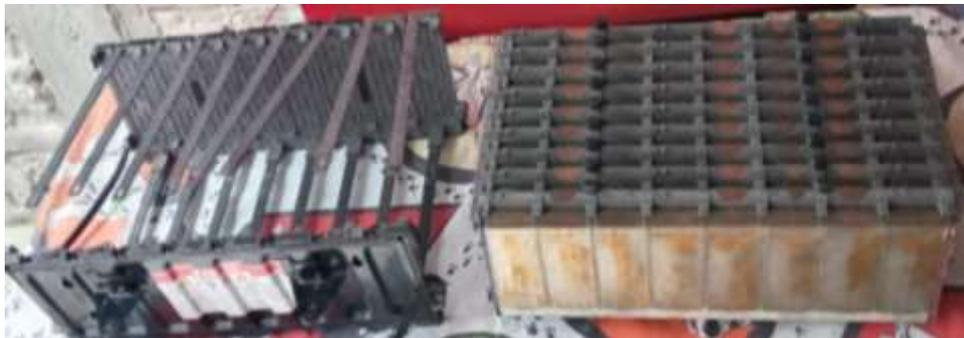
*Nota.* En la imagen podemos observar el cuerpo de celdas de una batería HV
