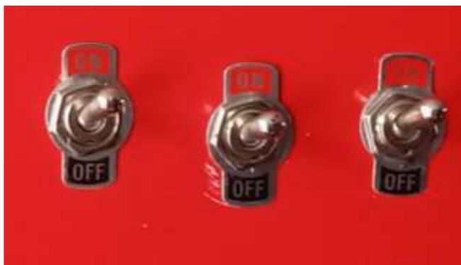
*Nota.* En la siguiente figura se observa los interruptores utilizados para el respectivo banco de pruebas son de un material metálico de acero inoxidable y de una larga duración.
