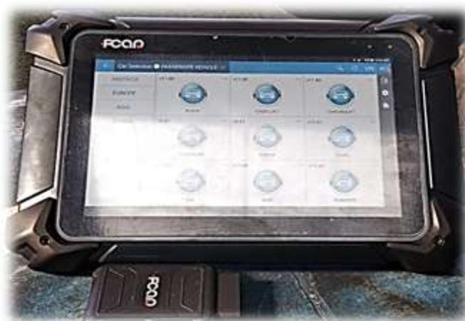
*Nota.* En la siguiente figura podemos observar el scanner FCar que permite detectar las diferentes fallas y averías del vehículo.
