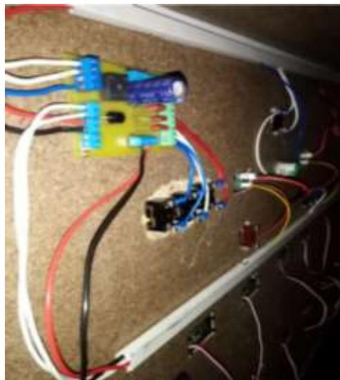
Después de soldar toda la placa empezamos desde los bornes de la placa mismo a conectar a los diferentes elementos de control para que podamos empezar hacer funcionar a todo el circuito, pero ya instalado en el banco de pruebas con todos los elementos ya acertados en la parte frontal del módulo.
