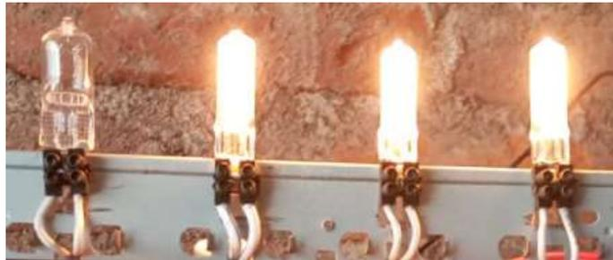
*Nota.* En la imagen podemos observar la activación de los 3 focos halógenos para una descarga más rápido de la batería HV.
