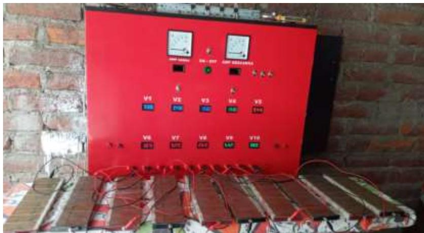
*Nota.* En la imagen podemos apreciar las conexiones hacia las celdas averiadas por parte de cada voltímetro
