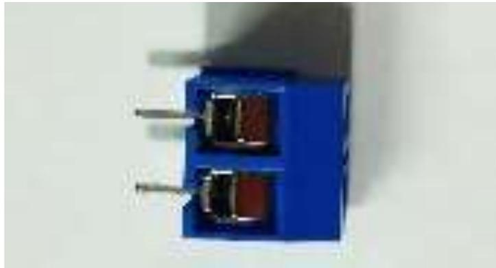
*Nota.* La figura anterior se puede observar la bornera de color azul que permitirá la conexión de las respectivas bananas y a su vez permite la conexión negativa y positiva en el banco de pruebas.
