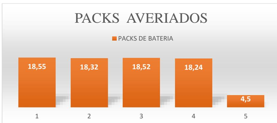
*Nota.* Podemos apreciar un diagrama de barras donde se observa los diferentes voltajes de celdas averiadas internamente el cual nos produce una caída de tensión en cada pack siendo el pack numero 5 el más defectuoso.
