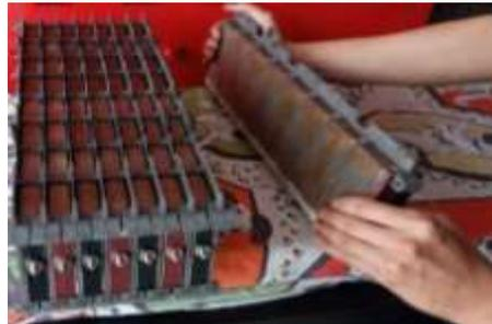
*Nota.* Aquí se puede observar el cambio de celdas para el montaje de la batería
