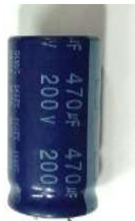
*Nota.* El condensador electrolítico será capaz de almacenar cierto voltaje para que no haya descarga en el circuito luego de su desactivación del banco de pruebas.
