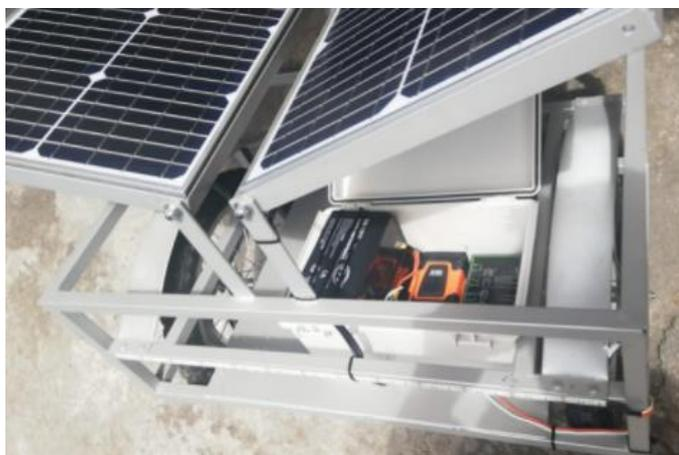
*Nota.* Las baterías se conectaron en paralelo hacia el controlador de carga para que salga de ahí al inversor de corriente y pueda cargar el sistema.
