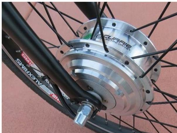
*Nota.* Motor HUB se pueden poner en la rueda posterior o delantera. Tomado de (Biobike, 2020)
