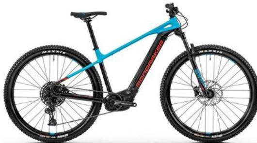
*Nota.* Mondraker PRIME con motor central Bosch Performance CX Gen4 y batería integrada de 625 Wh. Tomado de (Biobike, 2020)
